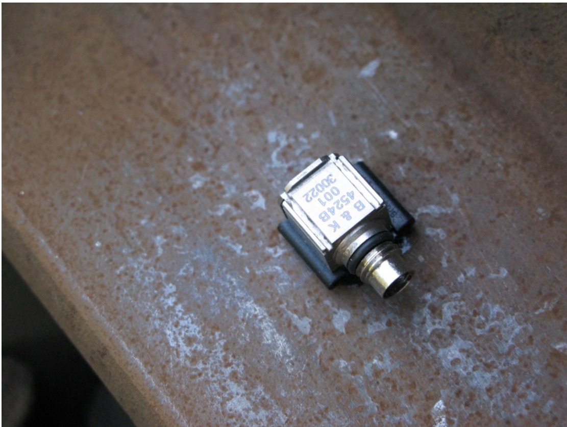
Obr. 4. 9 Umístění snímače na podložce na patu kolejnice
