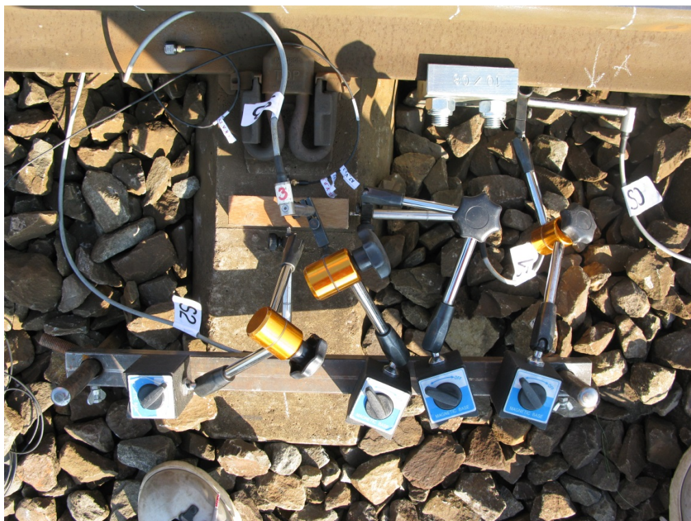
Obr. A. 5 Měřící aparatura na upevnění Pandrol FCI
