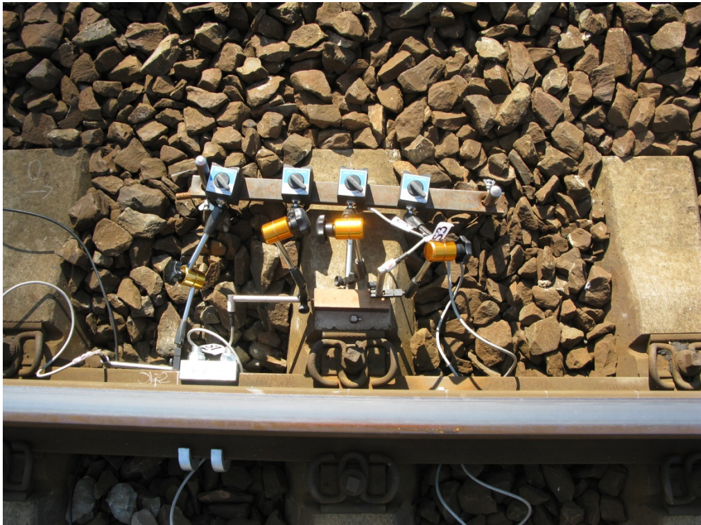
Obr. A. 4 Měřicí aparatura na upevnění Vossloh W14
