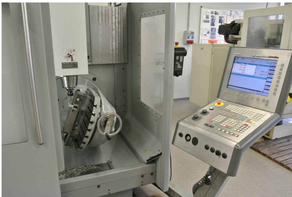
Obr. 36 DECKEL MAHO DMU 50 – 5osé CNC obráběcí centrum.
