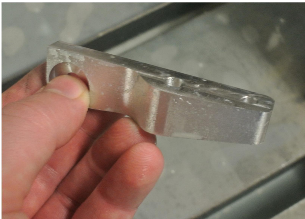
Obr. 46 Dolní držák po čtvrtém upnutí.
