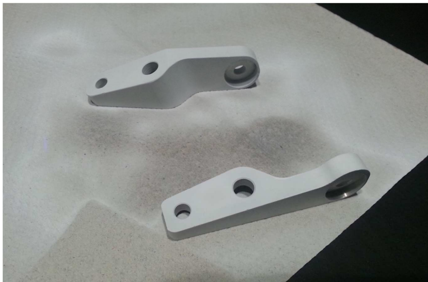
Obr. 50 Držáky řízení s nástřikem antireflexní vrstvy.
