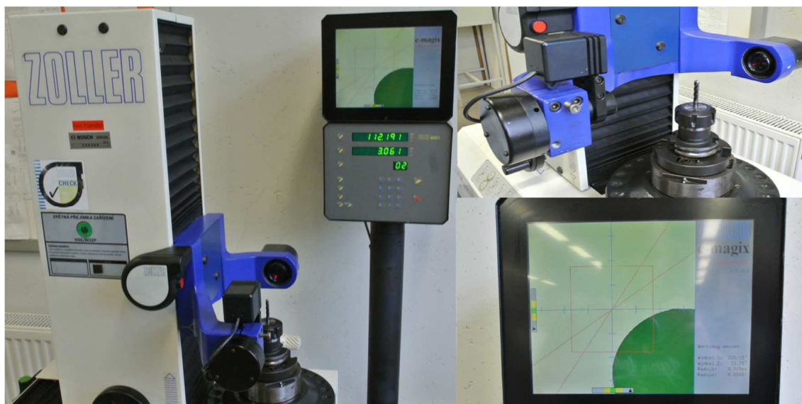
Obr. 39 Měření délkové a poloměrové korekce nástrojů na měřicím stroji Zoller.
