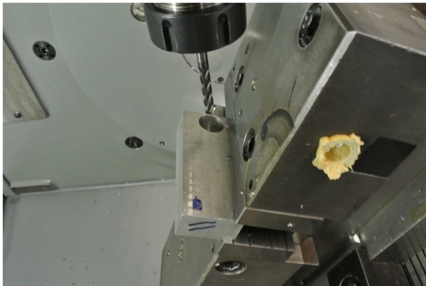
Obr. 41 Obrábění válcového zahloubení o průměru 17 mm.
