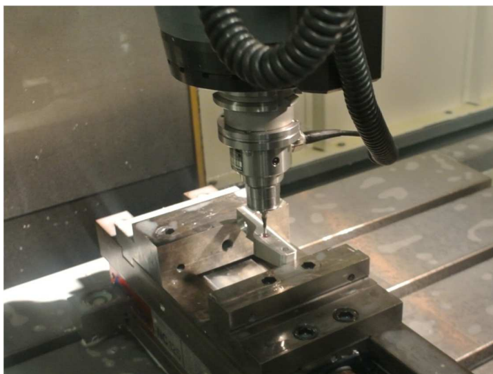
Obr. 47 Kontrola ustavení dolního držáku v pátém upnutí.
