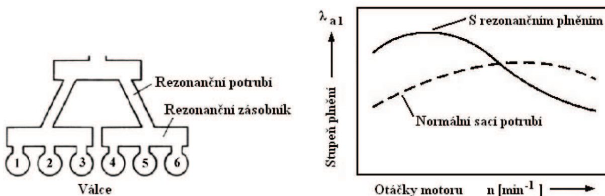
Obrázek 2.6 Uspořádání válců řadového šestiválcového motoru při rezonančním plnění a jeho vliv na stupeň plnění [1]
