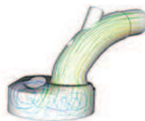
Obrázek 3.1 Počítačový model sacího kanálu[23]
