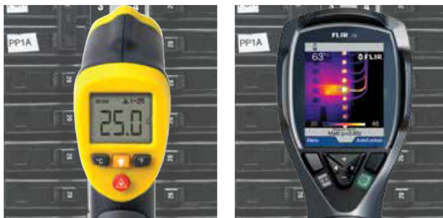
Obr. 3 Vlevo je pyrometr, který ukazuje teplotu v jednom bodě a vpravo termokamera značky FLIR, která měří teplotu v 3600 bodech najednou [22].
