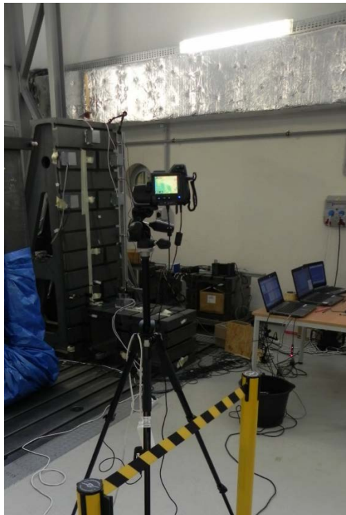
Obr. 16 Připravený experiment č.1 Simulace tepelného zatížení rámu výrobního stroje. Na obrázku je termokamera namířená na část měřeného rámu.
