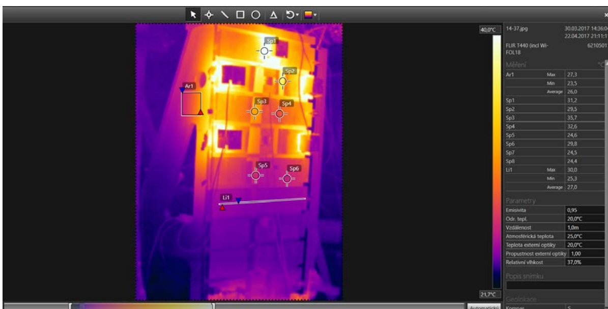
Obr. 14 Na obrázku je vrchní část rámu z experimentu č.1, obrázek je upravován v programu FLIR Tools a jsou na něm měřící body (Sp1-Sp6), Dále je v něm umístěna křivka (Li1), která v kartě vlevo ukazuje maximální, minimální a průměrnou teplotu, vlevo nahoře je obdélník (Ar1), tedy vybraná oblast, ze které program, stejně jako u přímky, ukazuje minimální, maximální a průměrnou teplotu
