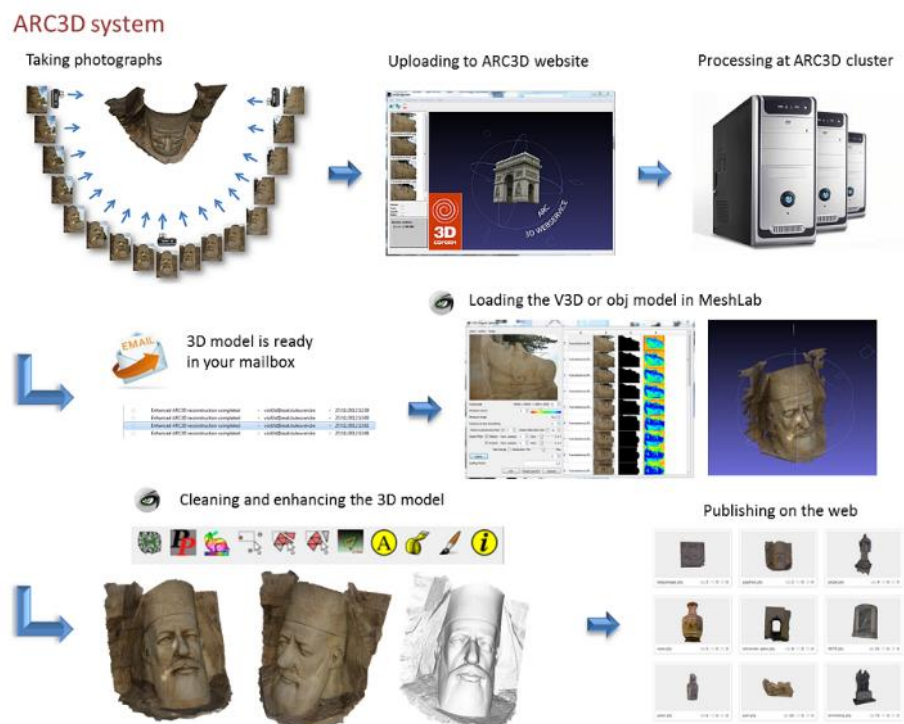
Obr. č. 11. – grafické znázornění vytváření modelu pomocí online služby ARC 3D Webservice 1)
