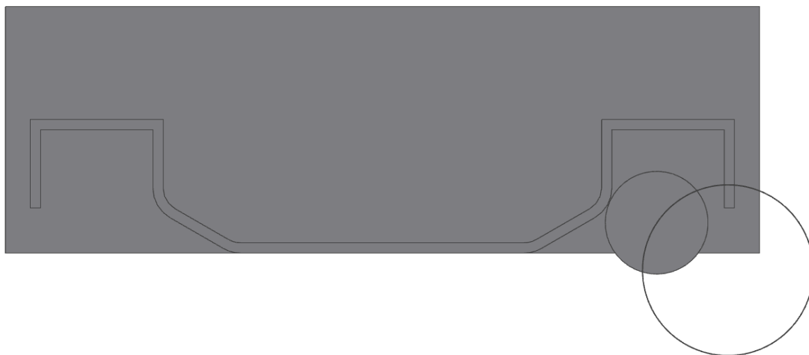
Obr. 41 Sestava pro ověření funkce algoritmu. Vstupní hodnoty: b_0=220\text{mm} , \varnothing D=50\text{mm} , \varnothing d=30\text{mm} , Rb_2=10\text{mm} , b_{11\text{min}}=10\text{mm} , p=13\text{mm} , b_1=1\text{mm} , b_{15}=10\text{mm} .
