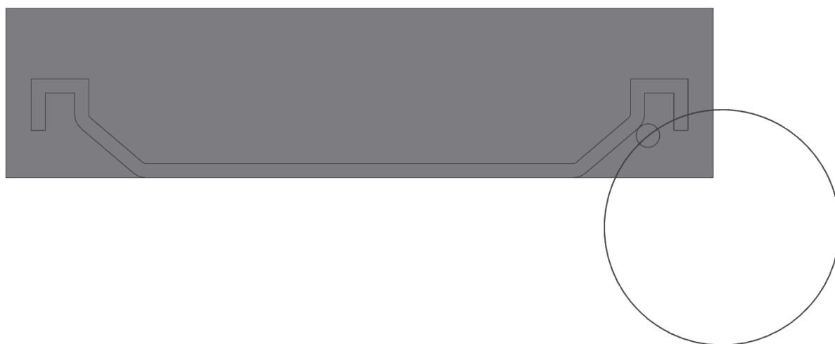
Obr. 42 Sestava pro ověření funkce algoritmu. Vstupní hodnoty: b_0=150\text{mm} , \varnothing D=50\text{mm} , \varnothing d=5\text{mm} , Rb_2=4\text{mm} , b_{11\text{min}}=1\text{mm} , p=14,2\text{mm} , b_{15}=10\text{mm} .
