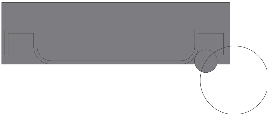
Obr. 39 Sestava pro ověření funkce algoritmu. Vstupní hodnoty: b_0=200\text{mm} , \varnothing D=60\text{mm} , \varnothing d=20\text{mm} , R_{b2}=8\text{mm} , b_{11\text{min}}=5\text{mm} , p=8\text{mm} .
