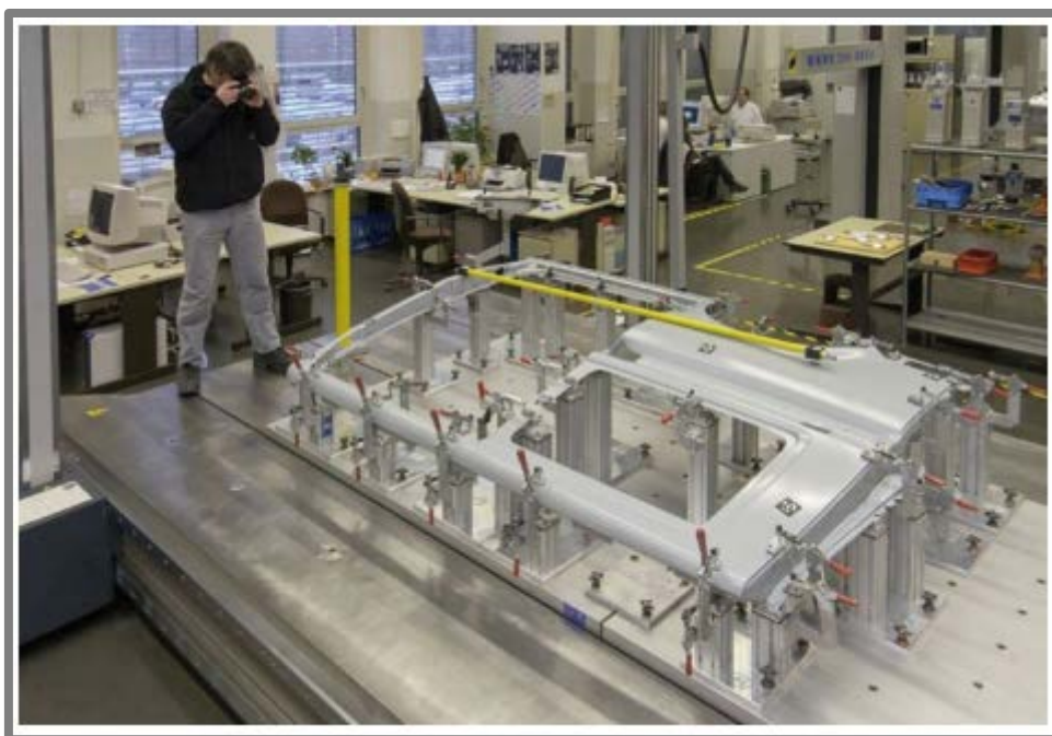
Obr. 1-1 Kontrola kvality pomocí fotogrammetrie [2]
