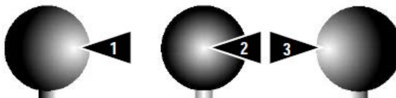
Obr. 2-20 Odraz blesku na světlém povrchu z různých pozic, u pozice 2 systém může omylem považovat odraz za referenční značku [4].
