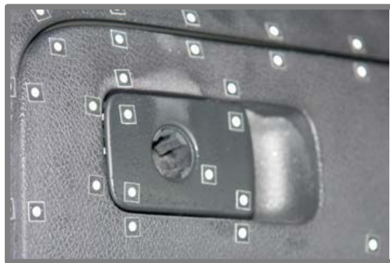
Obr. 2-1 Referenční značky na zkoumaném objektu [4]
