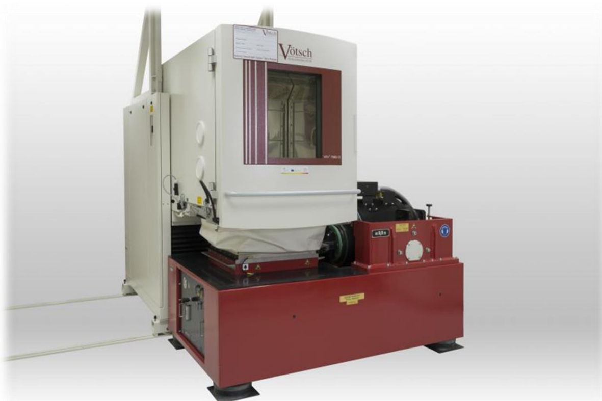
Obrázek 6.2: Vibrační systém RMS a klimatická komora Vötsch ve zkušebně CVVOZE [39]
