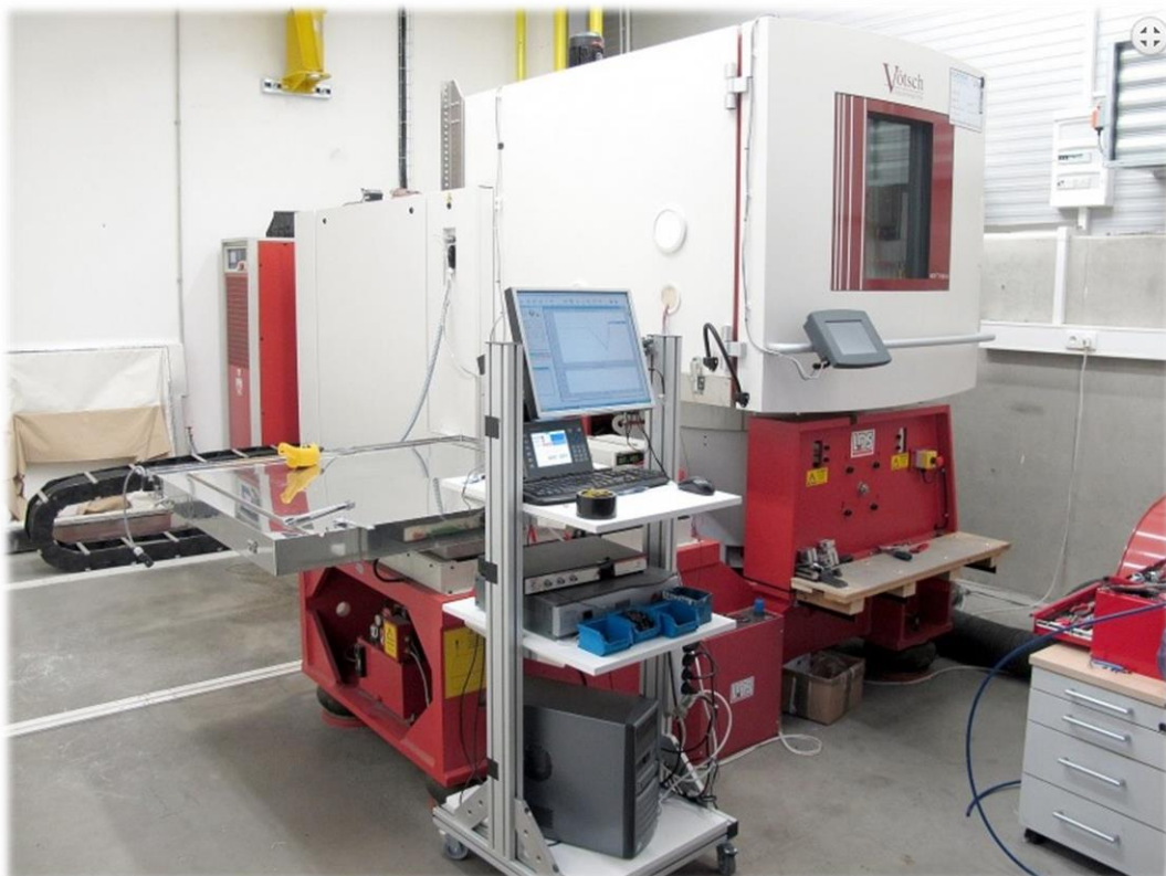
Obrázek 6.1: Firma SWELL: Vibrační systém LDS ve spojení s klimatickou komorou Vötsch [40]
