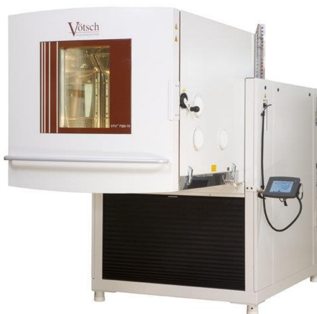
Obrázek 5.3: Klimatická komora Vötsch pro kombinované zkoušky [37]
