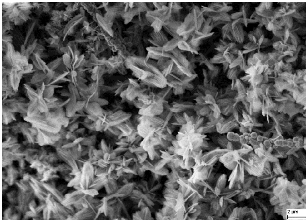
Obr. 11: Detailní snímek korozních produktů z Obr. 10, oblast 1, zvětšení 10000×
