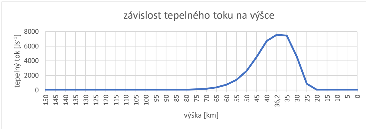
Graf 5-4 Změna velikosti tepelného toku objektu při sestupu atmosférou [12]
