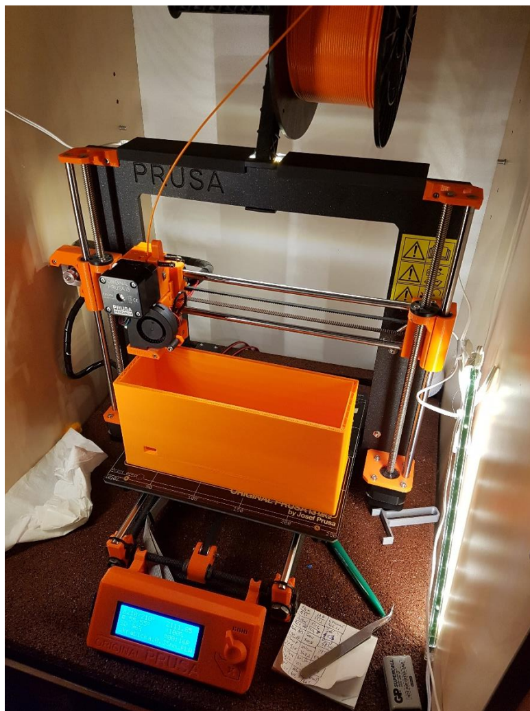
Obr. 11: Vlastní Original Prusa i3 MK2S při tisku krabice přípravku
