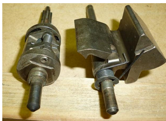
Obr. 16 Uzávěrka – odstředivé závaží a západka [14]
