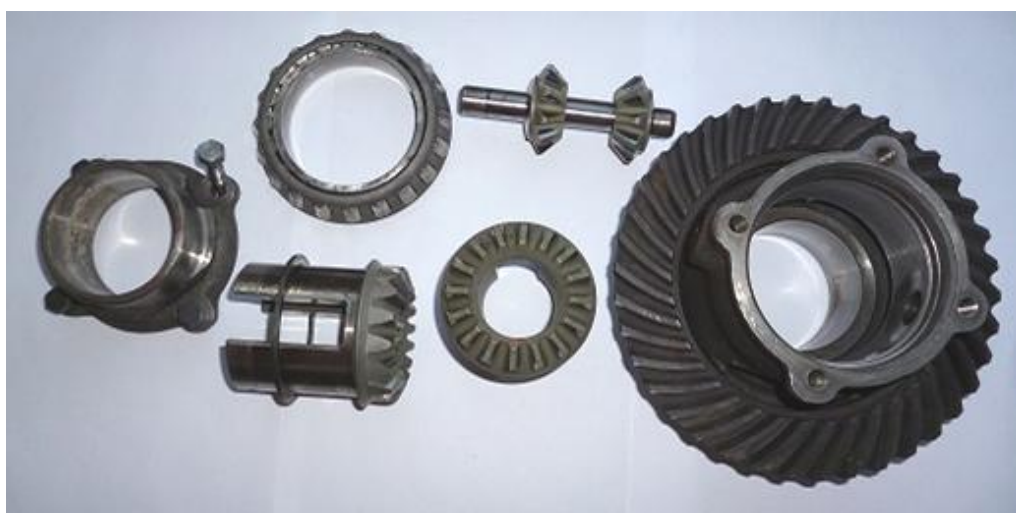
Obr. 6 Vnitřní konstrukce kuželového diferenciálu s podélně uloženým motorem - vozy Škoda 1000MB-130 [14]
