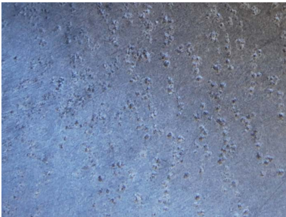
Obr. 7.2 Detail poškozeného povrchu sklářské formy
