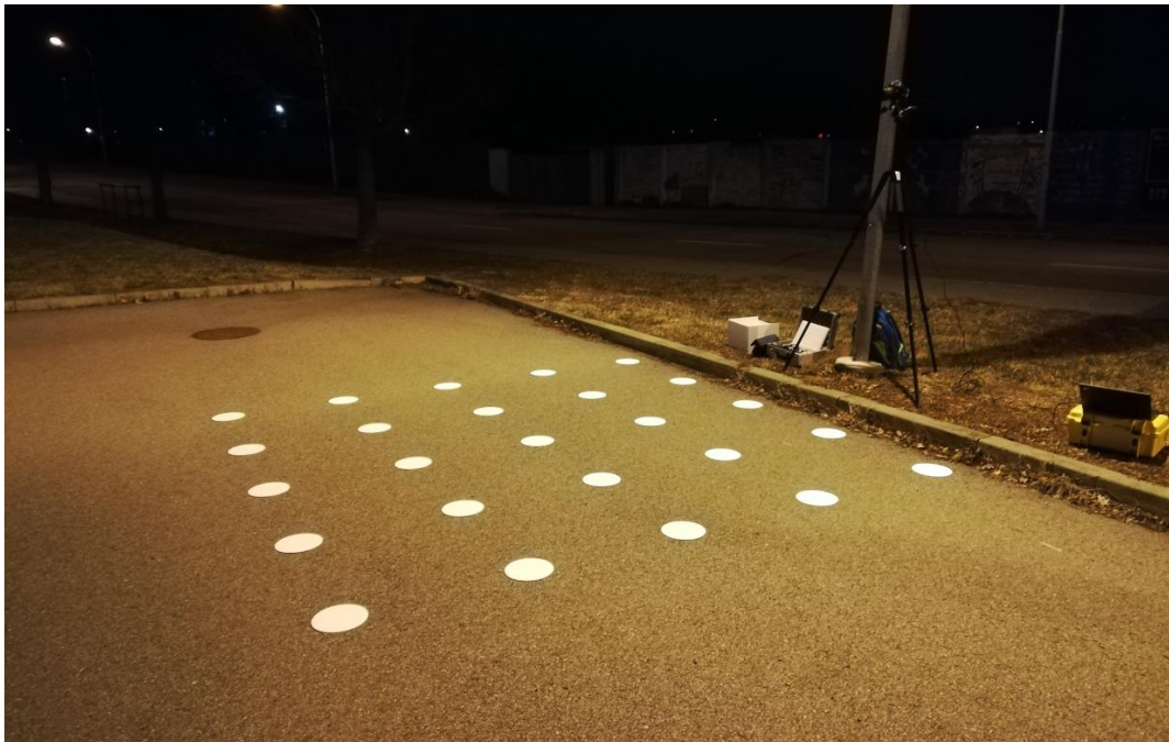
Obr. 36 Fotka měřené vozovky včetně sítě měřících vzorků
