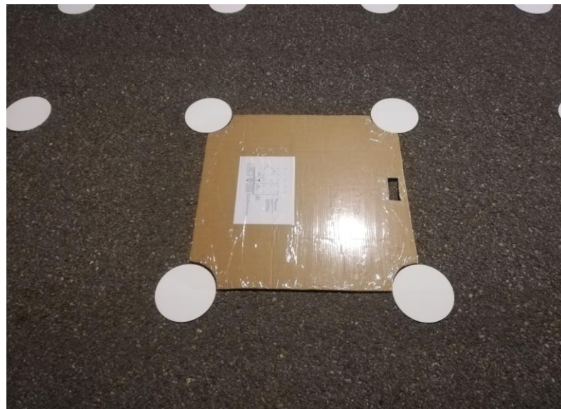
Obr. 35 Ukázka používání šablony pro rozmístění měřicích vzorků
