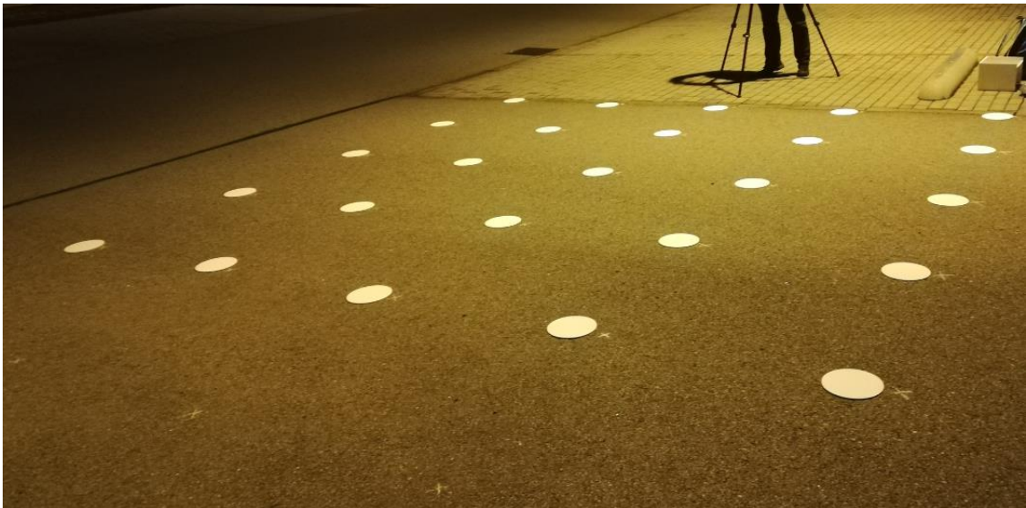
Obr. 32 Měřicí síť vzorků 5x5, rozteč 100x100 cm
