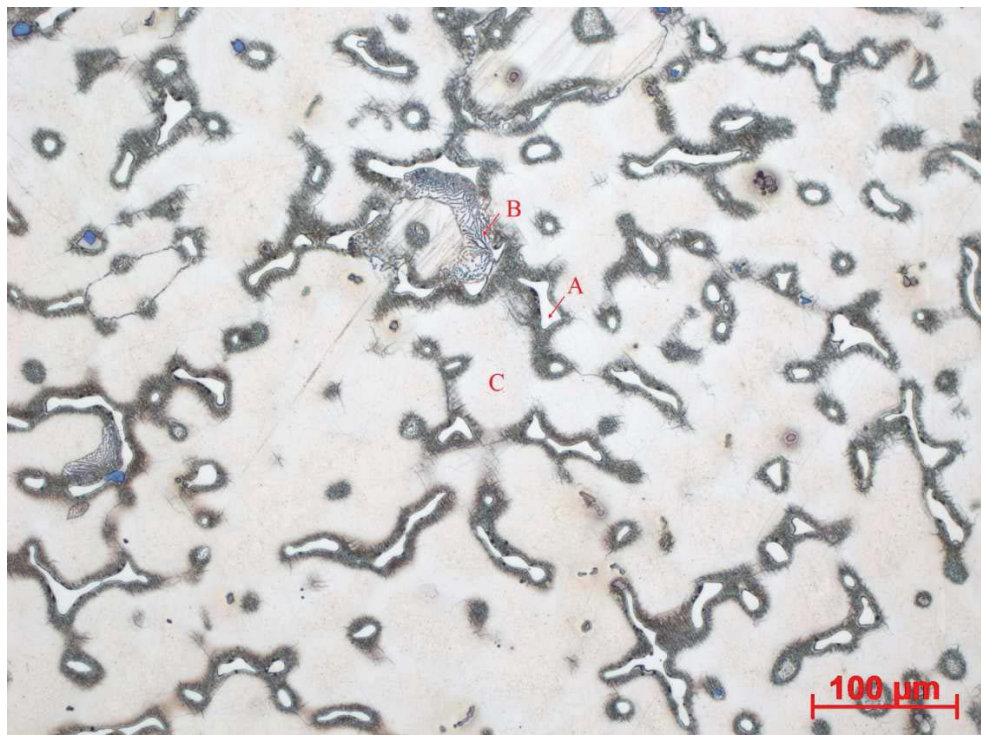
Obrázek 2 Struktura gravitačně lité slitiny AZ91 použité při řešení cílů předkládané práce, zvětšení 200x. A – \beta fáze, B – diskontinuální precipitát, C – \alpha fáze
