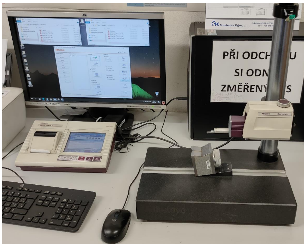
Obr. 37 Stanice na měření drsnosti povrchu.
