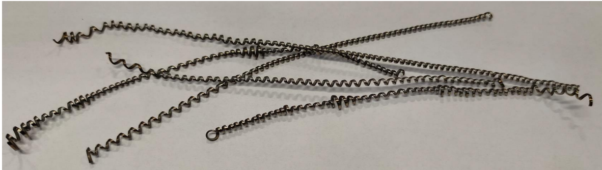
Obr. 39 Tříska ve formě dlouhé souvislé šroubovice.
