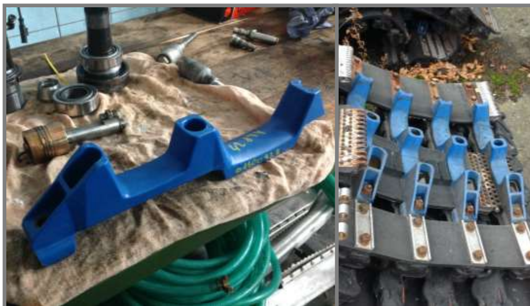
Obr.2-30 Dvouřadý vodič kol a jeho uchycení na pásu
