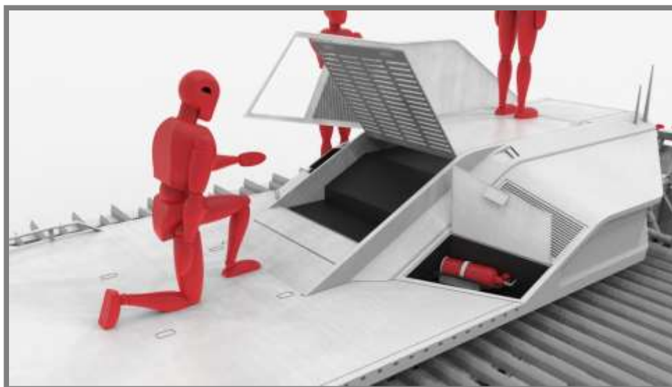
Obr.6-26 Servisní dvířka a úložný prostor s hasícím přístrojem
