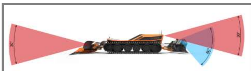
Obr.6-20 Zorné úhly Lidarů VLP-16 a snímače MultiSense S7 z bokorysu
