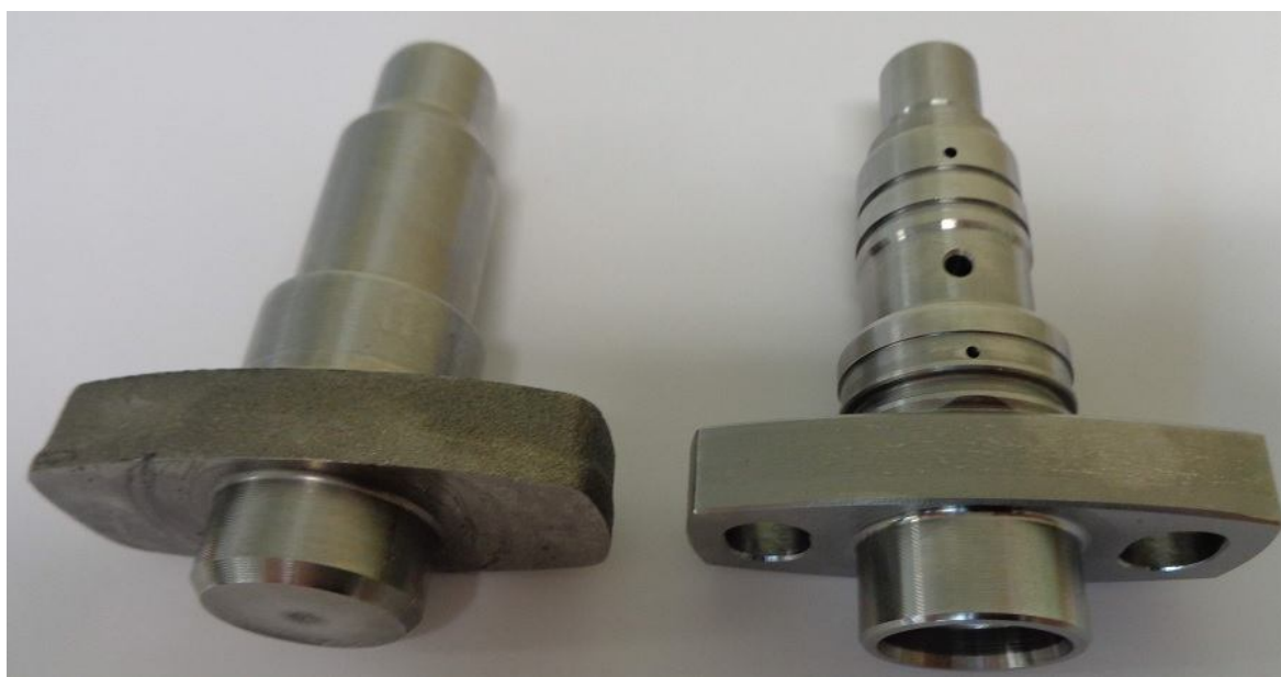
Obr. 2.1 Polotovar válce a dokončený válec před tepelnou úpravou
