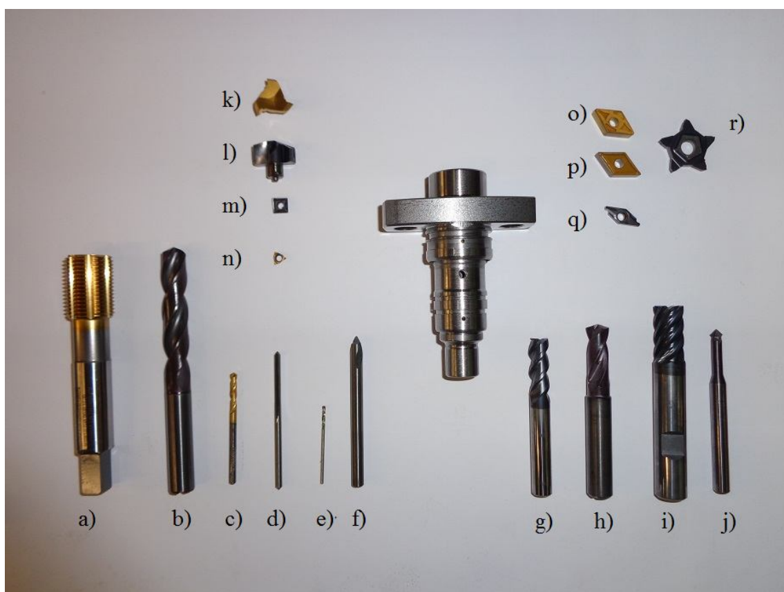
Obr. 3.4 Použité nástroje při opracování válce: a) tvářecí závitník, b) vrták hlavního otvoru, c) vrták sacího otvoru, d) výstružník sacího otvoru, e) vrták odpadních otvorů, f) srážecí sacích otvorů, g) fréza drážek na křídle, h) vrták pro otvory na křídle, i) fréza křídla, j) srážecí hran drážek na křídle, k) srážecí korunka na křídlo, l) vrtací korunka šachty, m) hrubovací VBD povrchu šachty, n) dokončovací VBD povrchu šachty, o) hrubovací VBD tvaru válce, p) dokončovací VBD tvaru válce, q) VBD čelního zapichování, r) VBD zapichovací Penta
