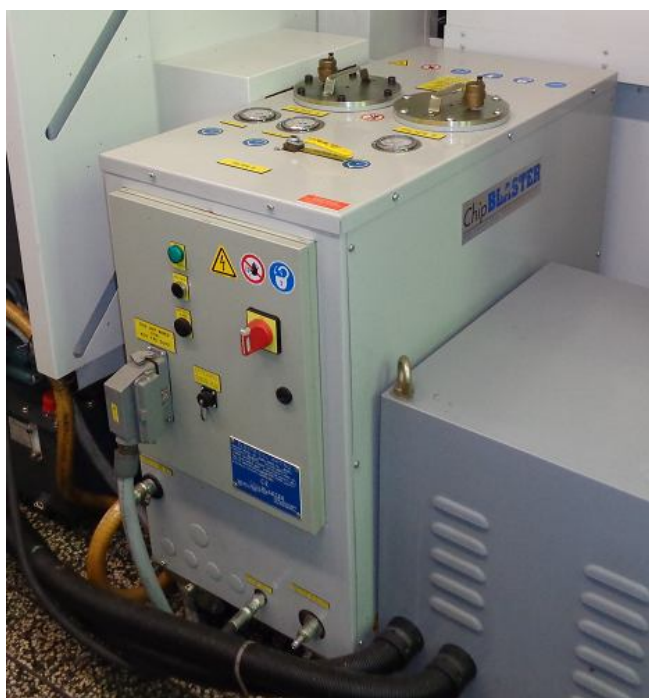
Obr. 3.3 Vysokotlaké čerpadlo značky Chip Blaster pro vnitřní chlazení vrtáku
