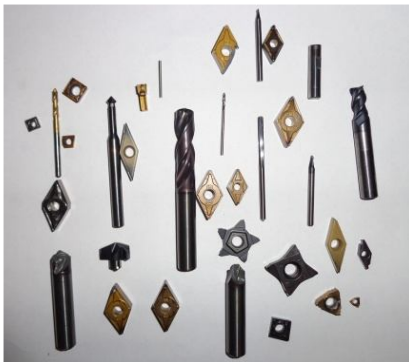
Obr. 6.1 Otupené a olámané nářadí po odepsání
