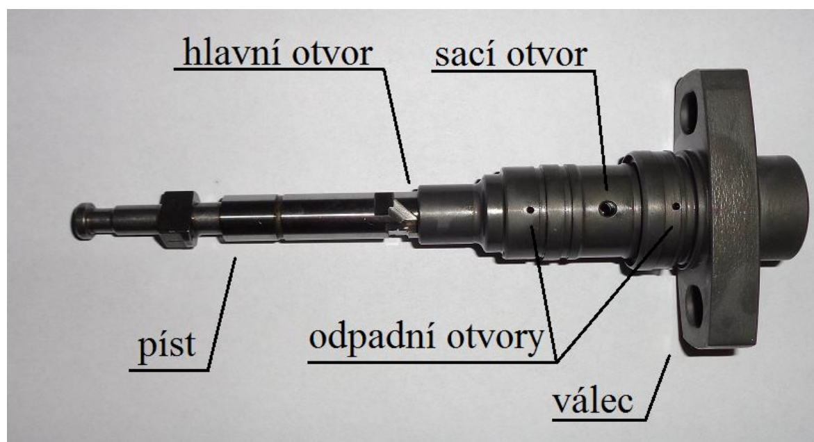
Obr. 1.2 Element vstřikovací jednotky
