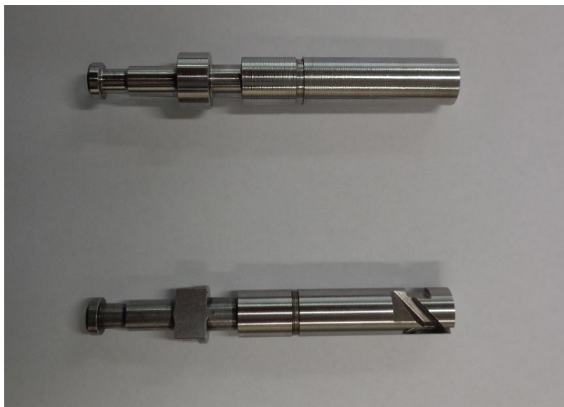
Obr. 1.1 Polotovar pístu a píst v konečné podobě před párovým broušením
