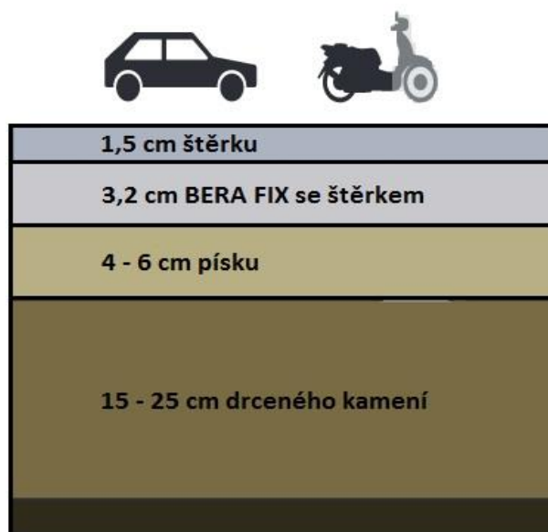
Obr. 4.3.3.1 Tloušťky vrstev zpevněné plochy S1
