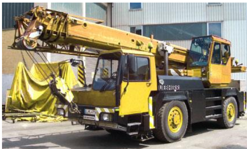
Obr. 7.3.1 Autojeřáb LIEBHERR LTM 1025
