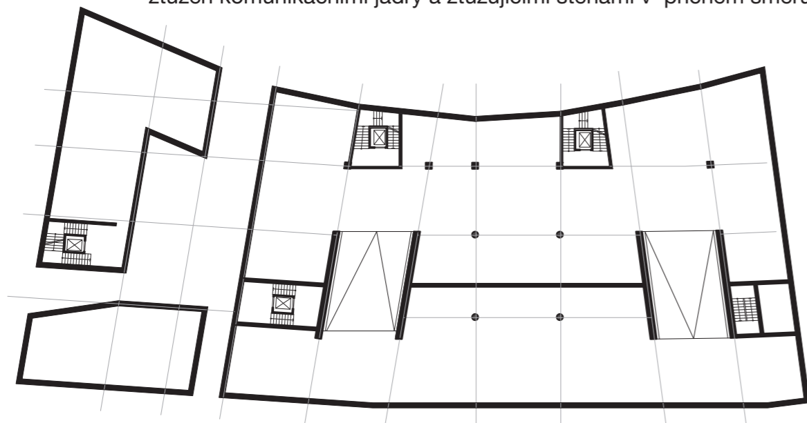
podzemní garáže- podélný železobetonový skelet ztužen komunikačními jádry a ztužujícími stěnami v příčném směru
