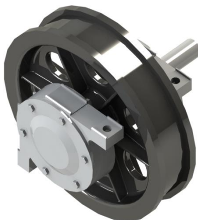
Obr. 6 - sestava hnacího pojezdového kola
