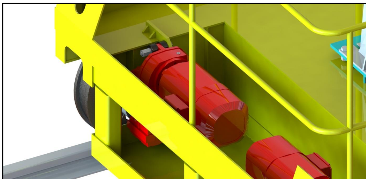
Příloha 2 - 3D pohled na motor pojezdu
