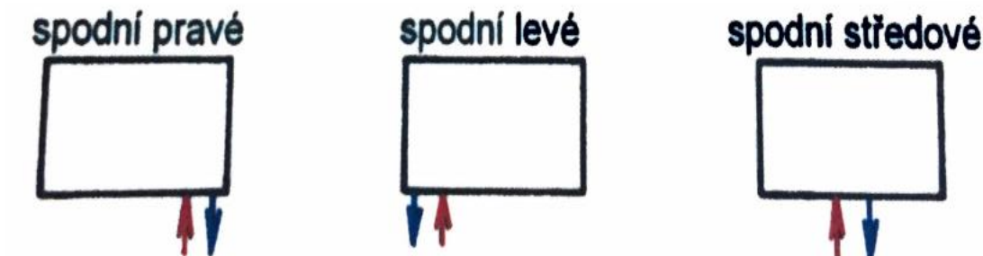
Obrázek 7 - Obecné možnosti připojení klasického otopného tělesa
