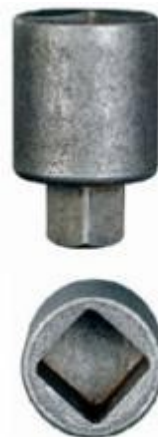
b) Protlaček - Protlačovaný profil [16]
