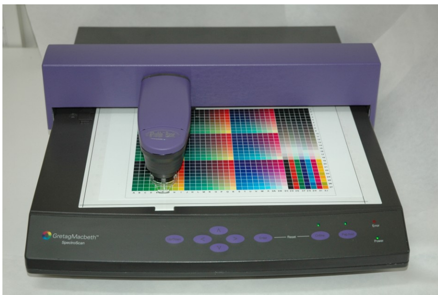
Obr. 14 Příklad přístroje Gretag Macbeth Spectroscan.
