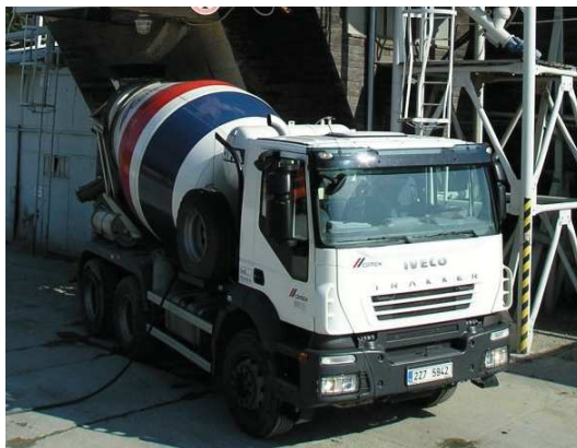
Obrázek H.3.7: Autodomíhávač s nástavbou Schwing Stetter C3, Basic Line, AM 6 C (zdroj: [36])
