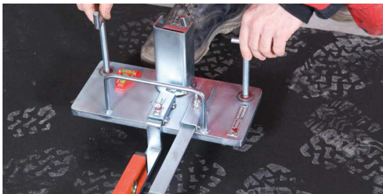
Obrázek E.7.1-1: Výškové nastavení přípravku (zdroj: [2])
