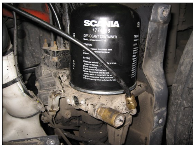
Foto č. 8 – Pohľad na vysúšač vzduchu
