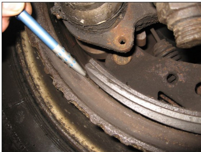
Foto č. 10 – Pohľad na brzdové obloženie 1. nápravy pravého kolesa (v stave nezabrzdenom)
