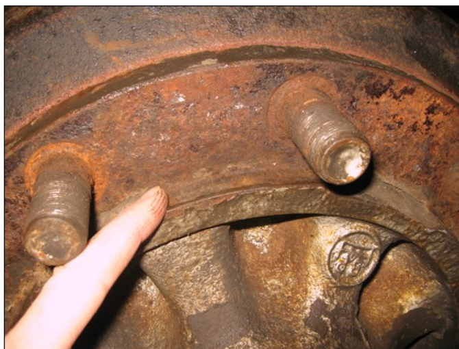
Foto č. 9 – Výrazná korózia bubna v oblasti stykových plôch
