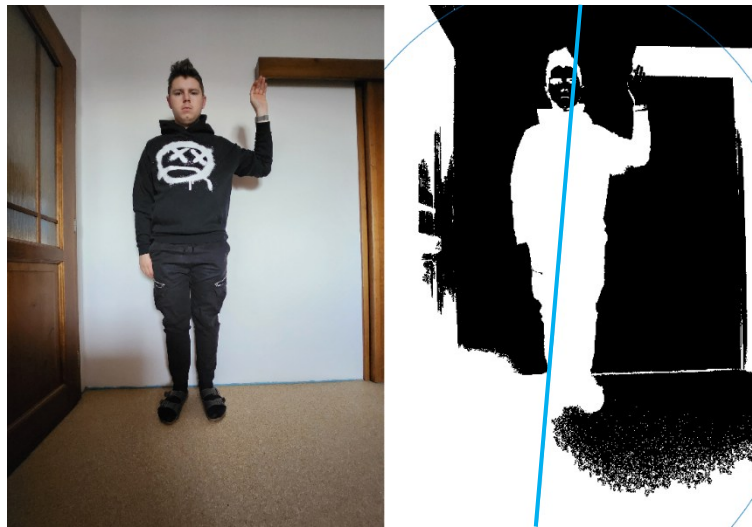
Obrázek 6.3 Výpočet momentů a převod do binárního obrazu za přítomnosti cizích objektů na obraze bez použití preprocessingu.
