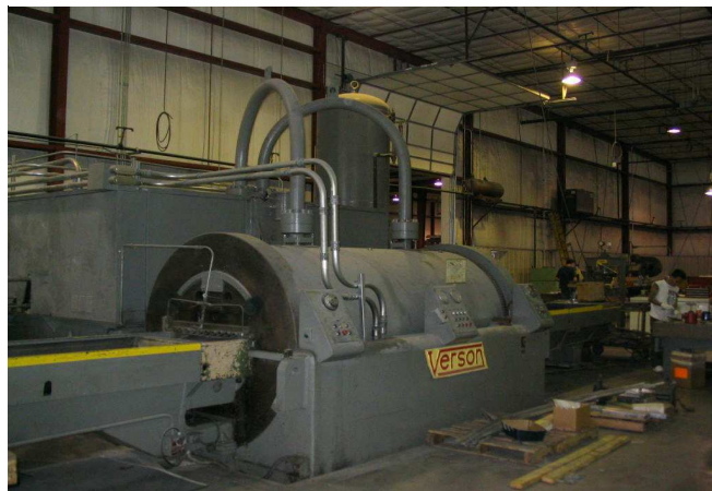
Obr. 13 Ukázka lisu Verson pro metodu Wheelon [16]
