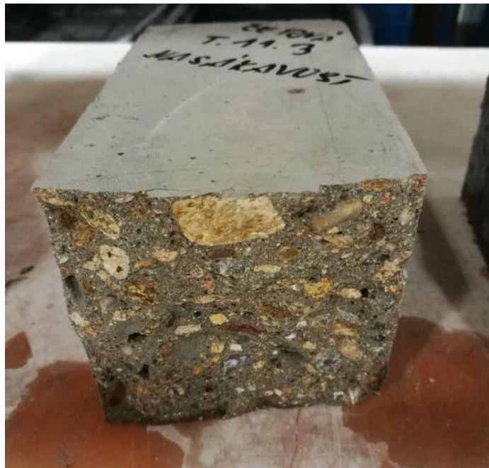
Obrázek 26 – Část zkušebního trávce na zkoušku nasákavosti
