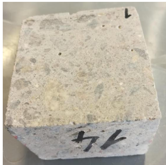
Obrázek 33 – Zkušební vzorek po zkoušce obrusnosti
