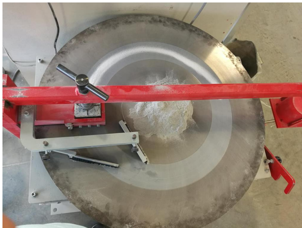
Obrázek 31 – Zkušební vzorek připraven na zkoušku obrusnosti
