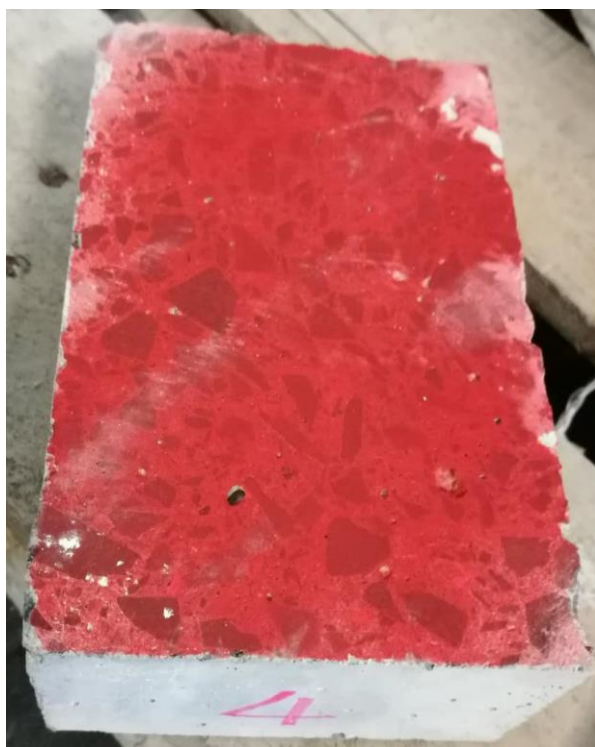
Obrázek 37 – Zkušební vzorek na zkoušku obrusnosti širokým kolem – řez
