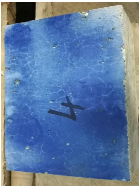
Obrázek 35 – Zkušební vzorek na zkoušku obrusnosti širokým kolem – výrobní povrch
