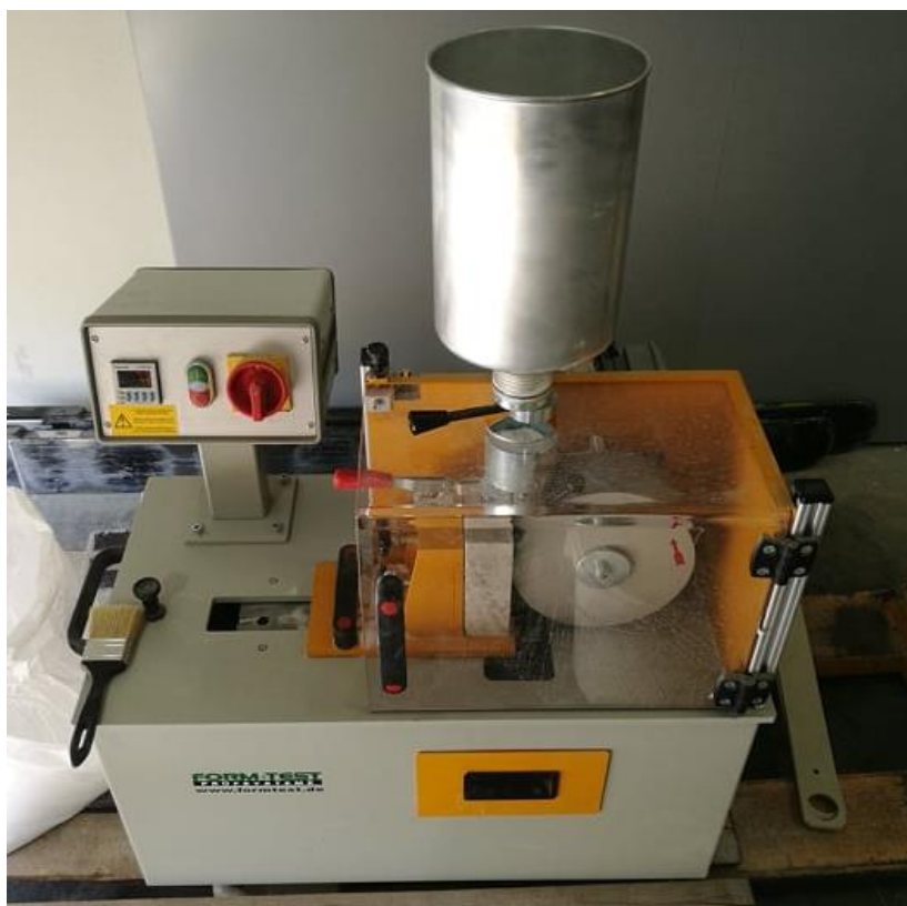
Obrázek 34 – Zkušební přístroj na zkoušku obrusnosti širokým kolem
