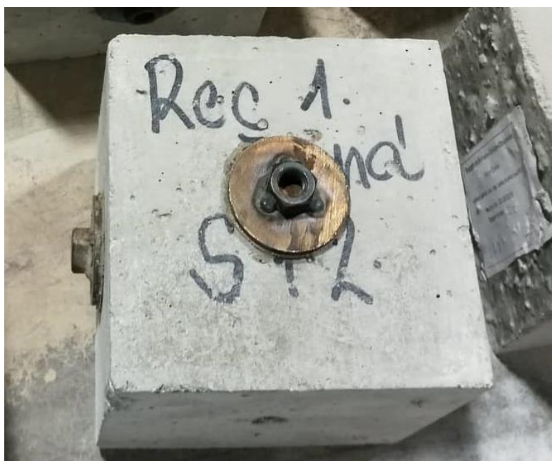
Obrázek 29 – Zkušební vzorek s nalepeným terčem na zkoušku pevnosti v tahu povrchových vrstev
