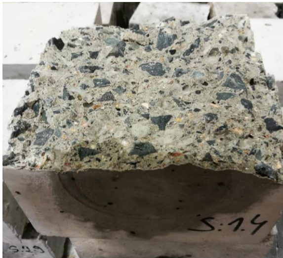
Obrázek 27 - Zkušební vzorek po zkoušce vodotěšnosti – 1 receptura
