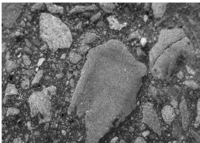
Obrázek 7 – Plocha pro zkoušce otěruvzdornosti na povrchu betonu s vodním součinitelem w = 0,36 [15]
