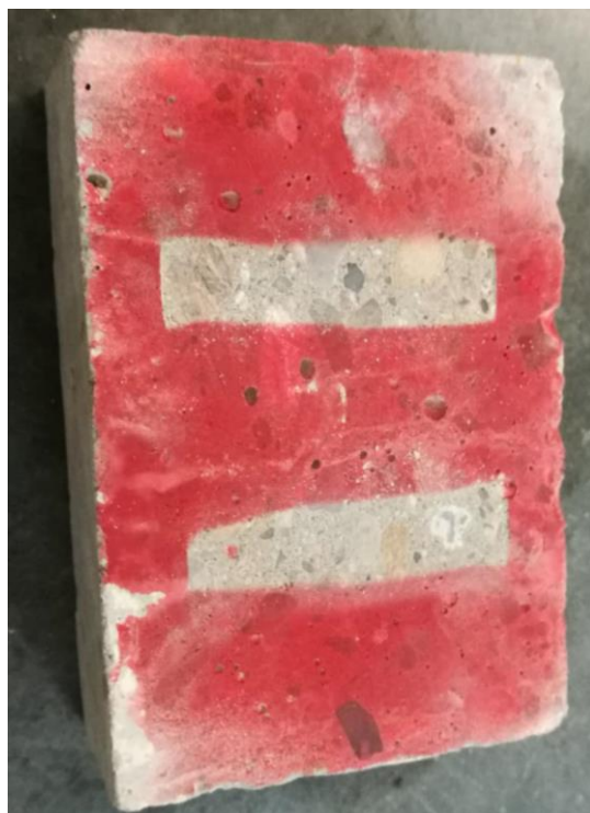
Obrázek 38 – Zkušební vzorek po zkoušce obrusnosti širokým kolem – řez
