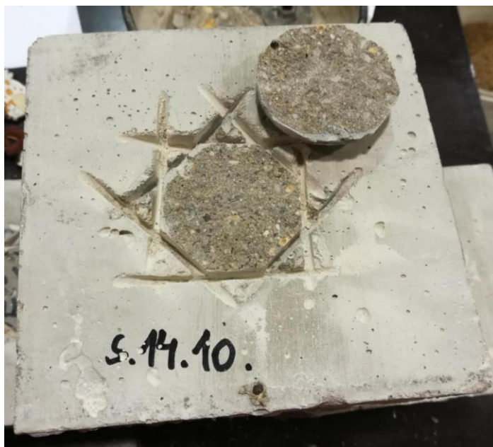
Obrázek 30 – Zkušební vzorek s odtrženým terčem po zkoušce pevnosti v tahu povrchových vrstev
