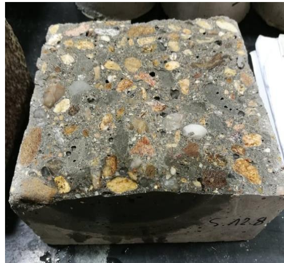
Obrázek 28 - Zkušební vzorek po zkoušce vodotěšnosti – 12 receptura
