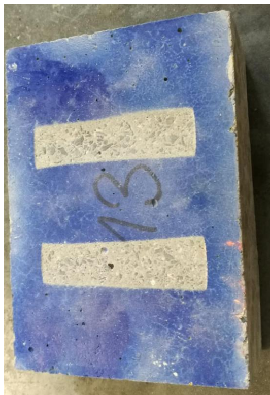
Obrázek 36 – Zkušební vzorek po zkoušce obrusnosti širokým kolem – výrobní povrch
