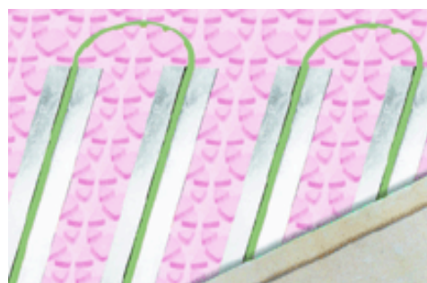
Obr. 17 Montáž suchého systému pomocí systémové desky
