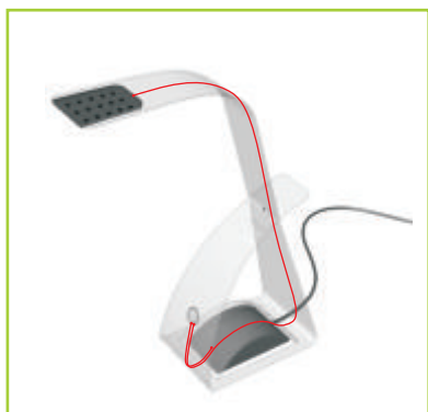
Obr. 4.19 Schéma rozvodu el. energie tělem lampy
