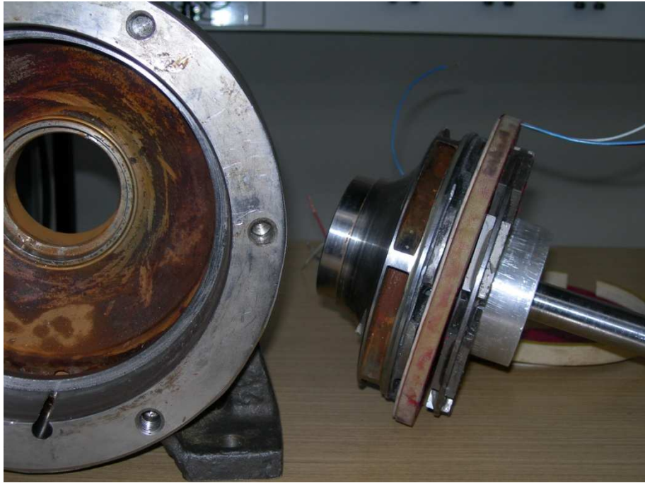
Obr. A. 3 Diskový motor před vložením do spirálové skříňe
