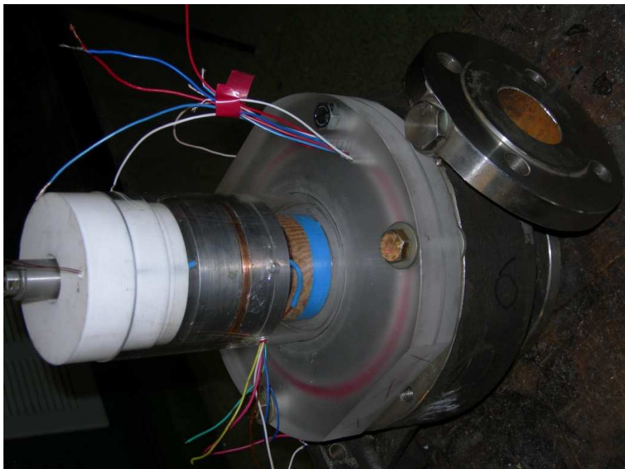
Obr. A. 6 Prototyp bezucpávkového odstředivého čerpadla ve složeném stavu
