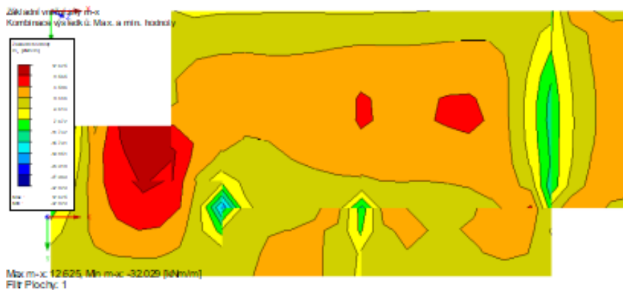
Obrázek 10: 3D model- výsledky momenty M_x
