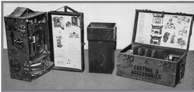
Obr. 1-4 rozložený polní rentgen
