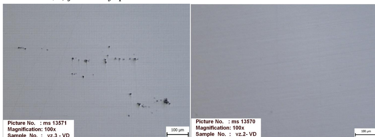
Obrázek 43 Vyhodnocení mikročistoty při 100x zvětšení a) nejhorší vzorek VD3 b) jeden z nejlepších vzorků VD2.
