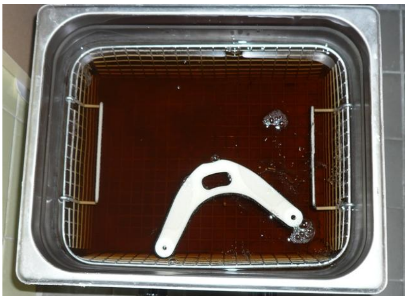
Obr. 3.6: Chemické odstranění materiálu podpor.
