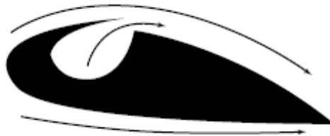
Obr. 9) Schéma tangenciálního vyfukování [5]
