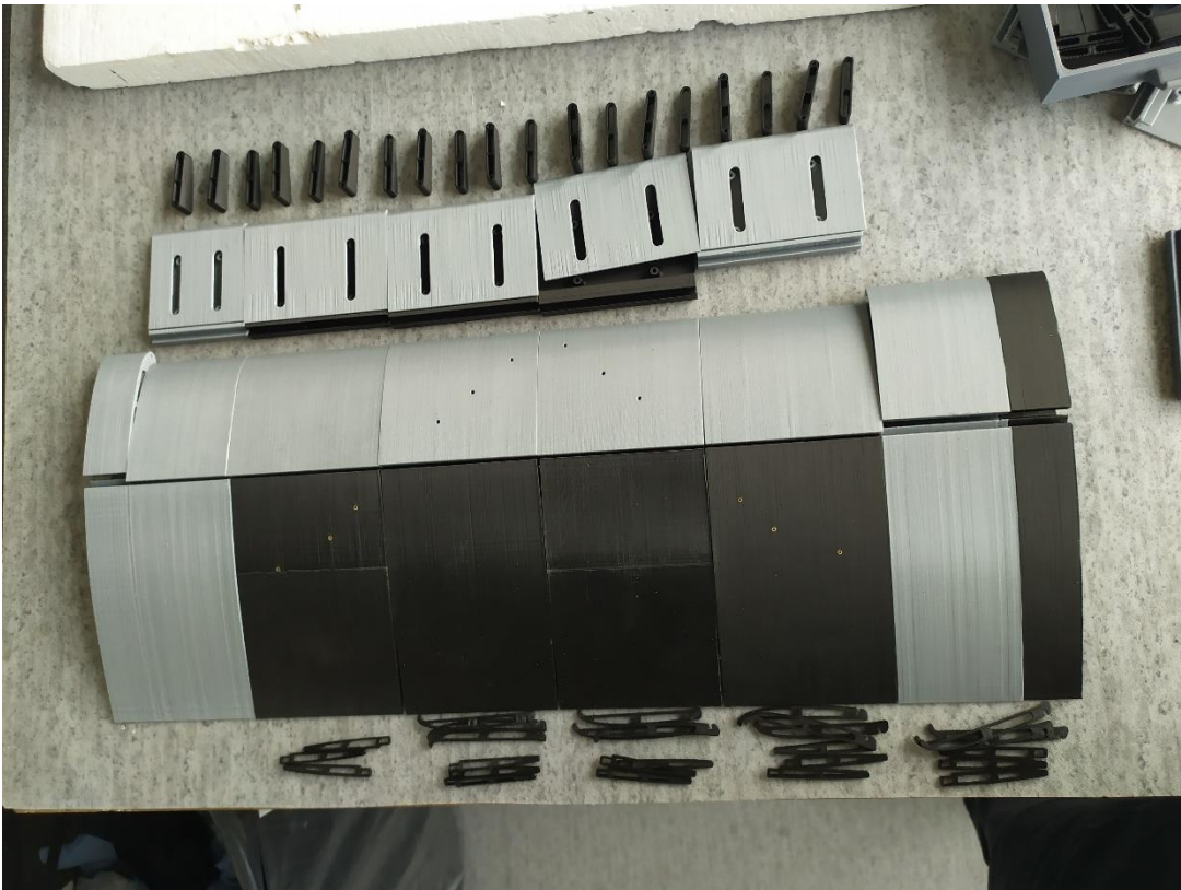
Obr. 87) Vytisknuté části profilu se štěrbinou
