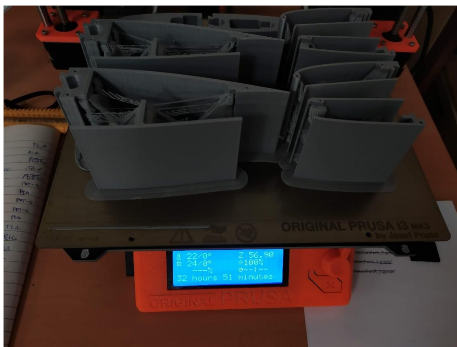
Obr. 86) Tisk částí na profil se šěrbinou
