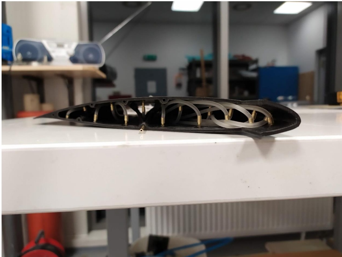
Obr. 83) Rozvod hadiček v čistém profilu
