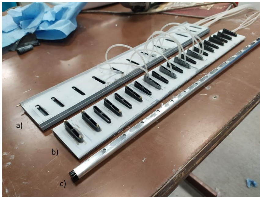
Obr. 45) Vyměnitelná část profilu, horní (a) i spodní (b), společně s frézovanou hliníkovou trubicou rozvádějící vzduch uvnitř modelu (c)
