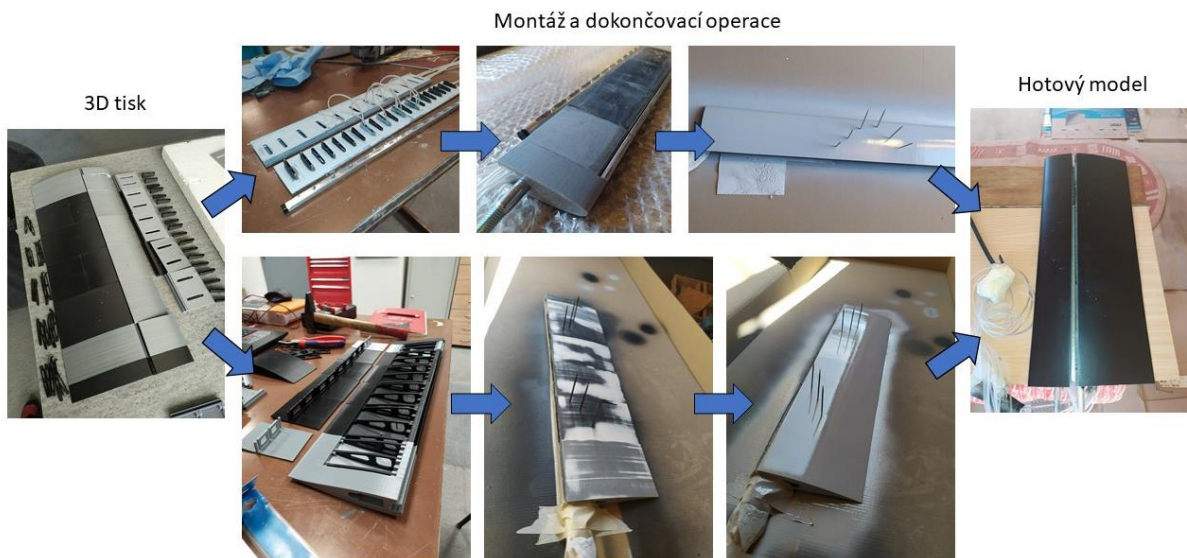
Obr. 46) Výrobní postup profilu se štěrbínou
