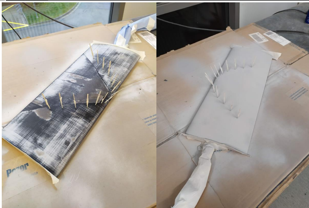
Obr. 85) Dokončovací operace čistého modelu
