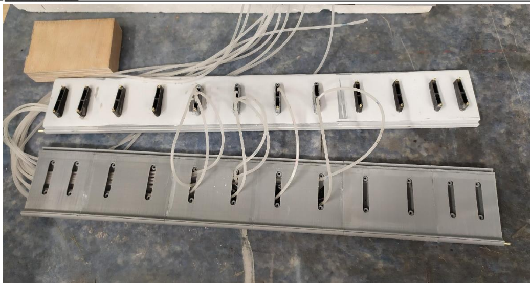
Obr. 89) Přední část profilu se štěrbinou při dokončovacích úpravách
