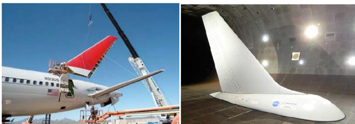
Obr. 15) SOP odebírané z vraku b757 (vlevo), SOP upravené k tunelovému měření (vpravo) [13]
