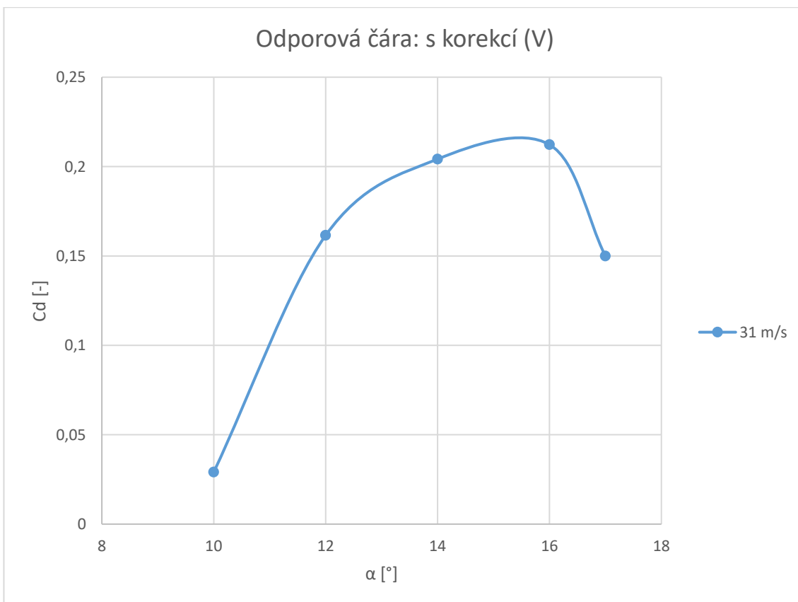
Obr. 121) Odporová čára při zapnutém aktivním řízení: A, s korekcí
