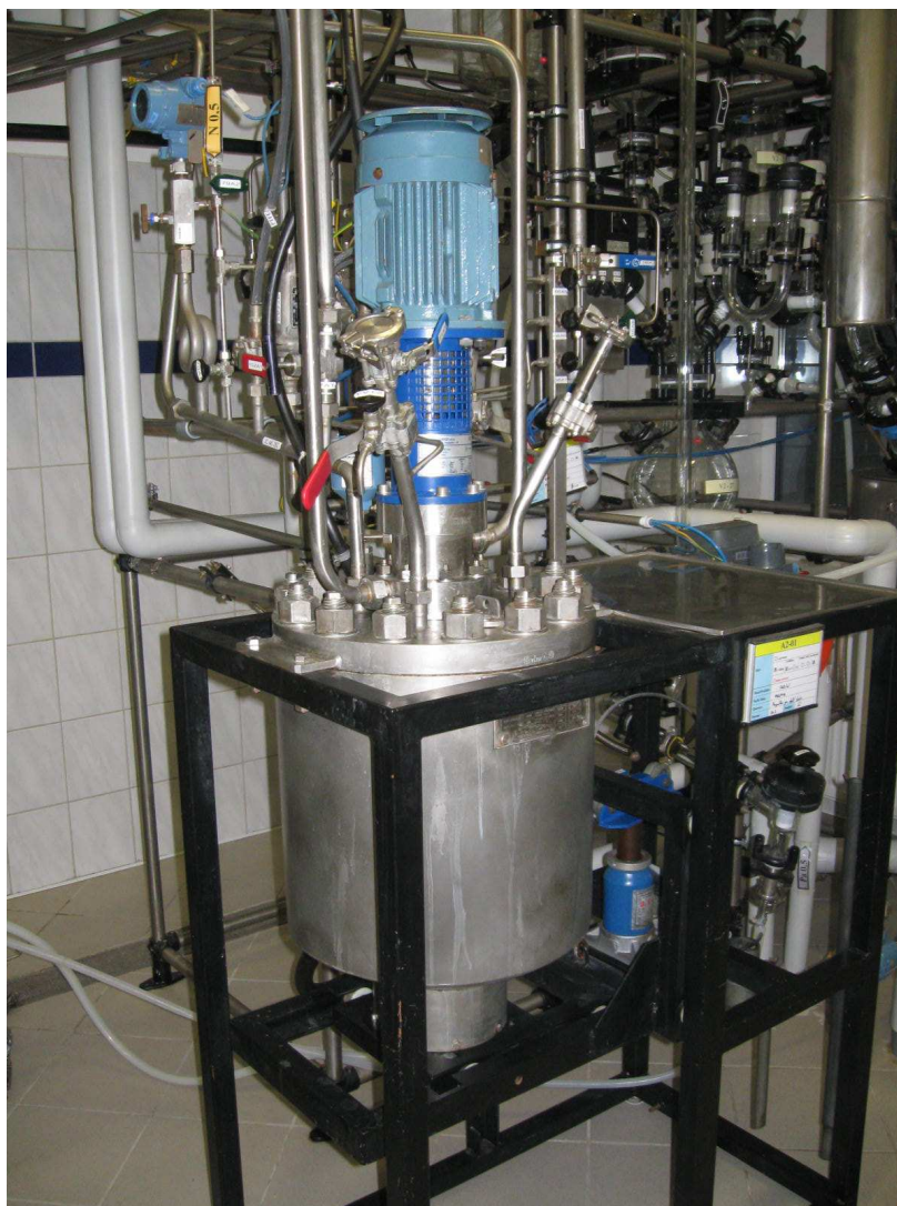
Obr. 9 Autokláv o objemu 20L, ve kterém probíhala výroba fingolimodu
