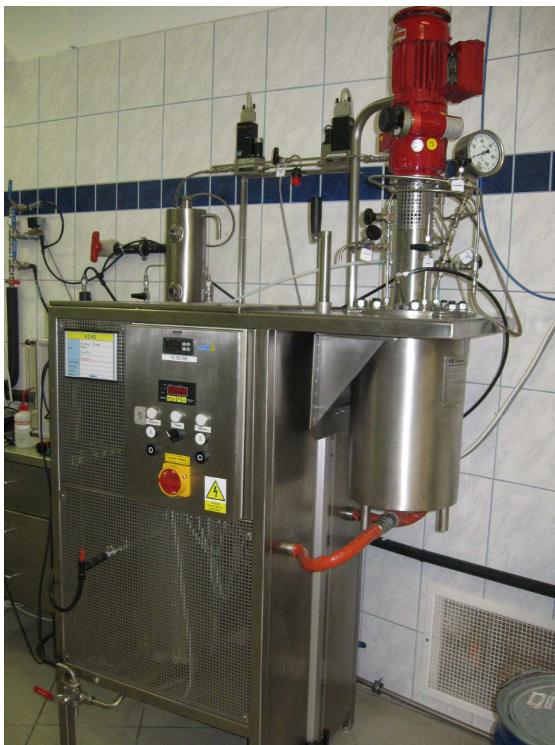
Obr. 8 Autokláv o objemu 5L, ve kterém probíhala optimalizace fingolimodu
