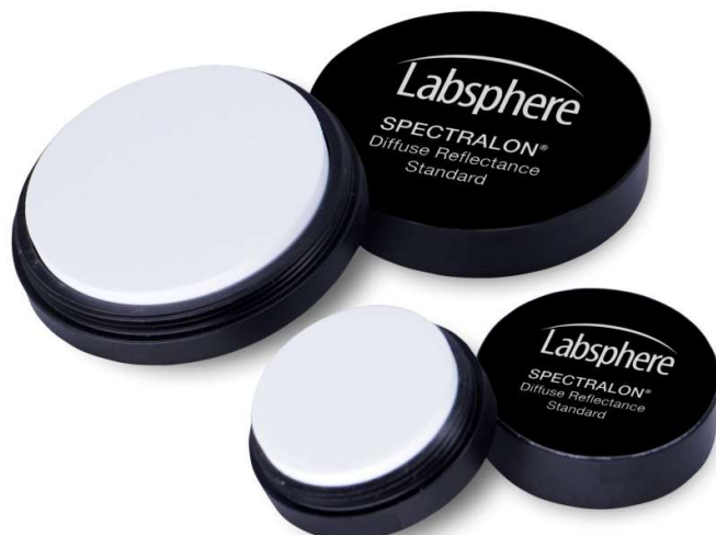
Obrázek 9.6: Etalon používaný pro kalibraci přístroje před měřením [7]
