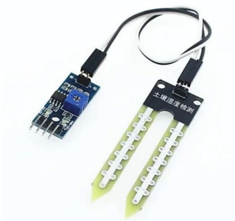
Obrázek 1.9 Odporové čidlo vlhkosti pro domácí projekty, převzato z [23]
