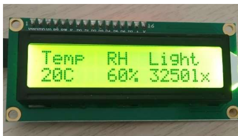
Obrázek 3.6 Zobrazení výchozích hodnot měřených veličin na testovacím displeji
