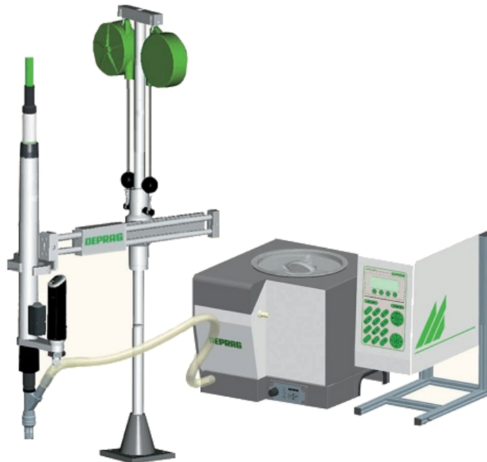
Obr. 7: Příklad elektrického vestavného šroubováku uchyceného v objímce stojanu s balancérem. Ke šroubováku je připevněna páka k ručnímu vedení a dále hadice pro přívod šroubů ze zásobníku. Elektronická řídicí jednotka se nachází v pravém dolním rohu obrázku.[10]
