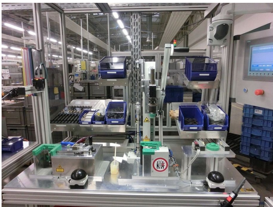
Obr. 37: Pracoviště na montáž vnitřního mechanismu vodního ventilu.
