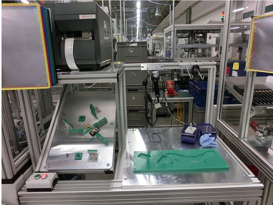
Obr. 44: Pracoviště na montáž spodního těsnění a kontrolu etikety.
