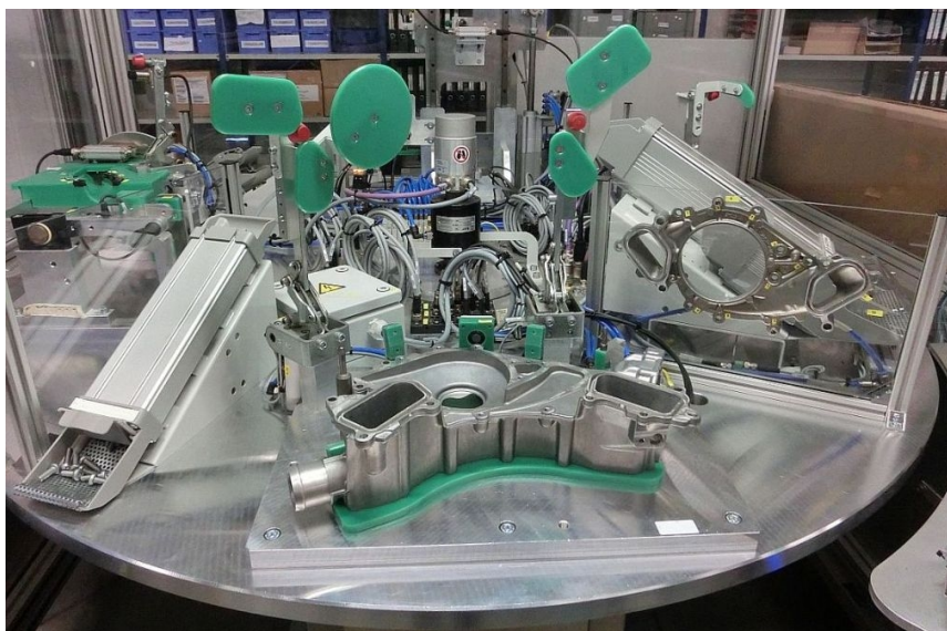
Obr. 33: Druhý přípravek šroubovacího pracoviště. V popředí se nachází tělo kanálové jednotky (D00), na které má být přiložen spodní kryt (D12). Zelené oválné plošky přípravku (za popsaným dílem) jsou určeny k zakrytí přesně opracovaných částí, které by mohly být šroubováním znekválněny.
