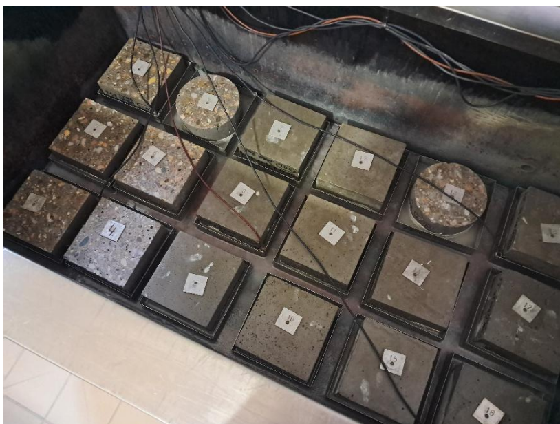
Obr. 13 – Vzorky během zkoušky stanovení odolnosti betonu proti CHRL metodou A
