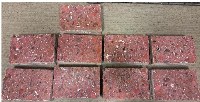
Obr. 22 – Vzorky připravené na mikroskopickou analýzu (zleva receptura 1, 2, 3 a 4, zezhora varianta A, B a C)
