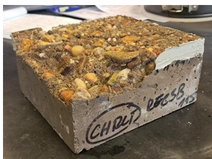
Obr. 28 – Vzorek po zkoušce CHRL – povrch vzniklý pomocí PTFE vložky s nátěrem hran – receptura 3B
