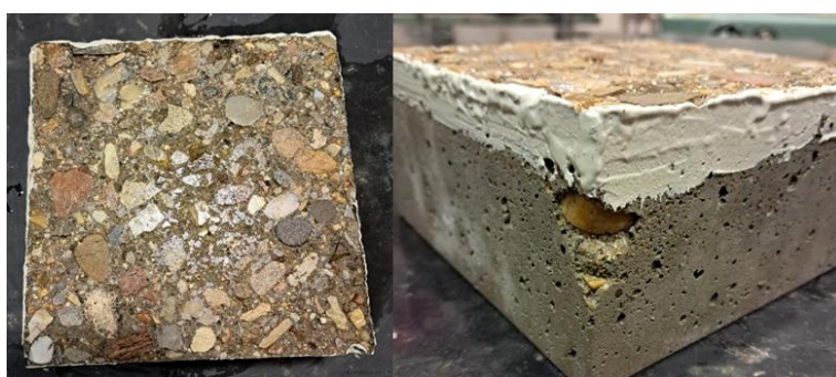
Obr. 29 – Vzorek po zkoušce CHRL – povrch vzniklý řezem s nátěrem hran – receptura 3B
