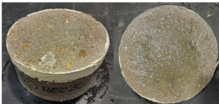
Obr. 64 – Válcové těleso – Vzorek po zkoušce CHRL – původní povrch s nátěrem hran – receptura 2C
