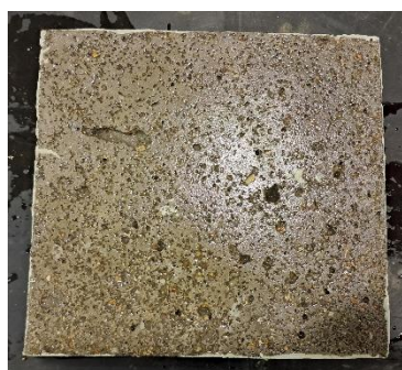
Obr. 67 – Vzorek po zkoušce CHRL – povrch vzniklý pomocí PTFE vložky s nátěrem hran – receptura 4B
