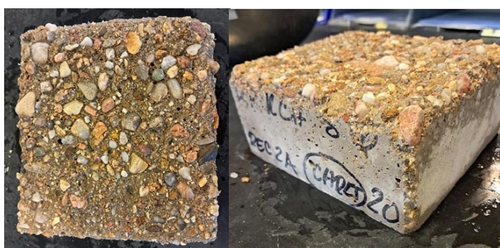
Obr. 46 – Vzorek po zkoušce CHRL – povrch vzniklý pomocí PTFE vložky bez nátěru hran – receptura 2A
