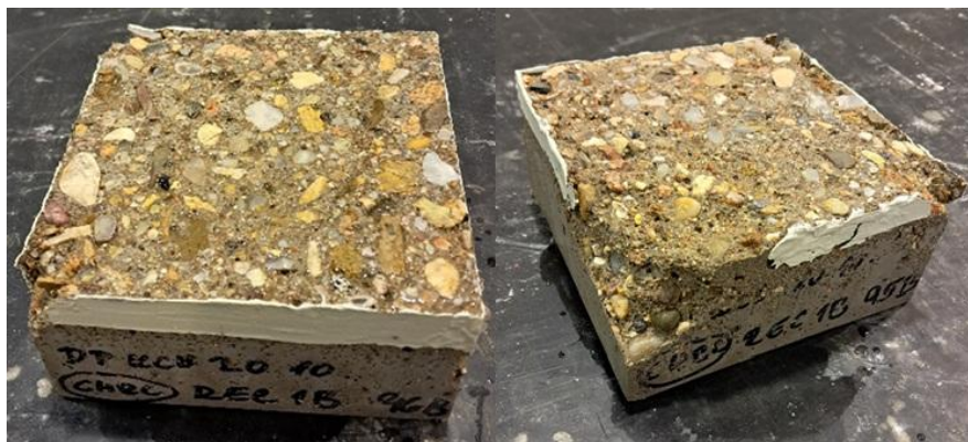
Obr. 41 – Vzorek po zkoušce CHRL – povrch vzniklý řezem s nátěrem hran – receptura 1B
