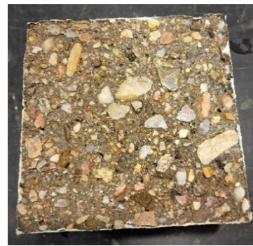
Obr. 65 – Vzorek po zkoušce CHRL – povrch vzniklý řezem s nátěrem hran – receptura 4B
