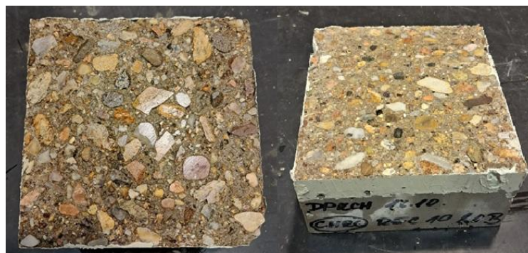
Obr. 43 – Vzorek po zkoušce CHRL – povrch vzniklý řezem s nátěrem hran – receptura 1C
