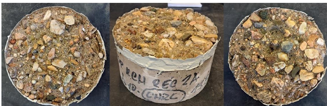
Obr. 51 – Vzorek po zkoušce CHRL – Válcové těleso – povrch vzniklý řezem s nátěrem hran – receptura 2A
