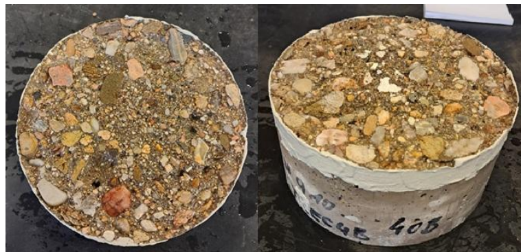
Obr. 69 – Válcové těleso – vzorek po zkoušce CHRL – povrch vzniklý řezem s nátěrem hran – receptura 4B
