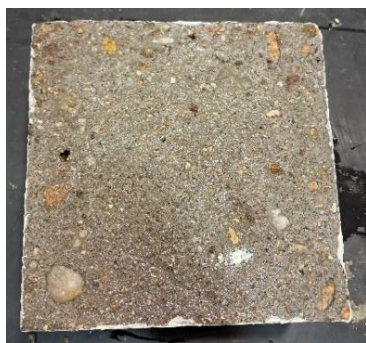
Obr. 54 – Vzorek po zkoušce CHRL – původní povrch s nátěrem hran – receptura 2B
