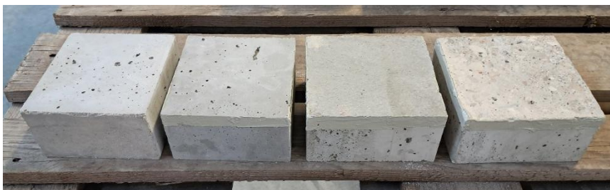
Obr. 25 – Zkušební vzorky připravené na zkoušku odolnosti betonu proti CHRL (zleva: povrch vzniklý pomocí teflonové vložky bez nátěru hran, povrch vzniklý pomocí teflonové vložky s nátěrem hran, původní povrch s nátěrem hran, povrch vzniklý řezem s nátěrem hran)
