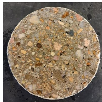
Obr. 63 – válcové těleso - Vzorek po zkoušce CHRL – povrch vzniklý řezem s nátěrem hran – receptura 2C
