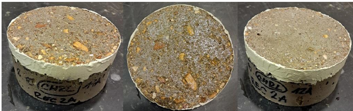
Obr. 50 – Vzorek po zkoušce CHRL – Válcové těleso – původní povrch s nátěrem hran – receptura 2A
