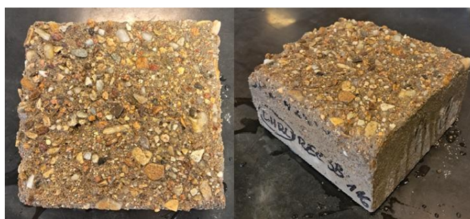
Obr. 27 – Vzorek po zkoušce CHRL – povrch vzniklý pomocí PTFE vložky bez nátěru hran – receptura 3B
