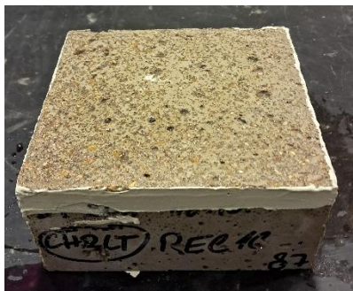
Obr. 44 – Vzorek po zkoušce CHRL – povrch vzniklý pomocí PTFE vložky s nátěrem hran – receptura 1C
