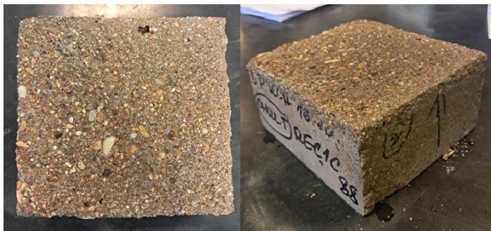
Obr. 45 – Vzorek po zkoušce CHRL – povrch vzniklý pomocí PTFE vložky bez nátěru hran – receptura 1C
