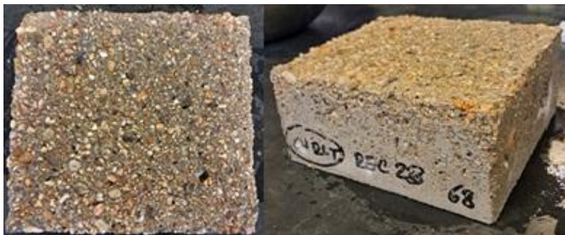
Obr. 55 – Vzorek po zkoušce CHRL – povrch vzniklý pomocí PTFE vložky bez nátěru hran – receptura 2B
