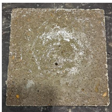
Obr. 72 – Vzorek po zkoušce CHRL – původní povrch s nátěrem hran – receptura 4C
