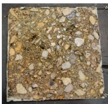
Obr. 52 – Vzorek po zkoušce CHRL – povrch vzniklý řezem s nátěrem hran – receptura 2B
