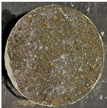
Obr. 70 – Válcové těleso – vzorek po zkoušce CHRL – původní povrch s nátěrem hran – receptura 4B
