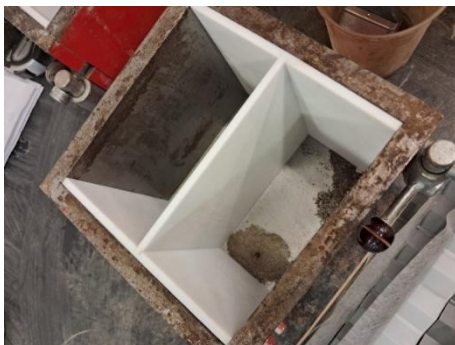
Obr. 24 - Teflonová vložka umístěná ve formě
