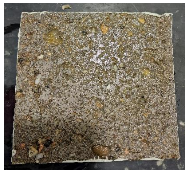
Obr. 35 – Vzorek po zkoušce CHRL – povrch vzniklý pomocí PTFE vložky s nátěrem hran – receptura 3C
