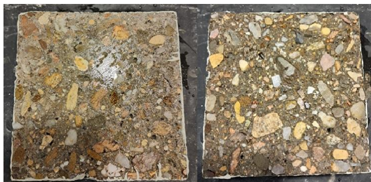
Obr. 73 – Vzorek po zkoušce CHRL – povrch vzniklý řezem s nátěrem hran – receptura 4C
