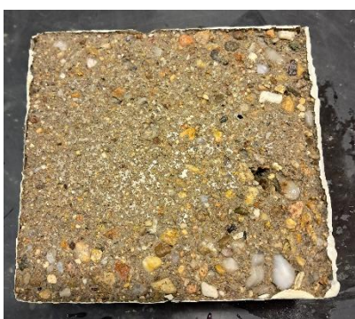
Obr. 47 – Vzorek po zkoušce CHRL – povrch vzniklý pomocí PTFE vložky s nátěrem hran – receptura 2A
