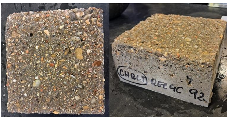
Obr. 74 – Vzorek po zkoušce CHRL – povrch vzniklý pomocí PTFE vložky bez nátěru hran – receptura 4C
