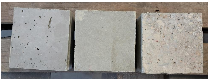
Obr. 26 - Rozdílné zkušební povrchy pro zkoušku odolnosti betonu proti CHRL (zleva: povrch vzniklý pomocí teflonové vložky, původní povrch, povrch vzniklý řezem)
