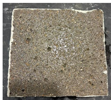
Obr. 53 – Vzorek po zkoušce CHRL – povrch vzniklý pomocí PTFE vložky s nátěrem hran – receptura 2B
