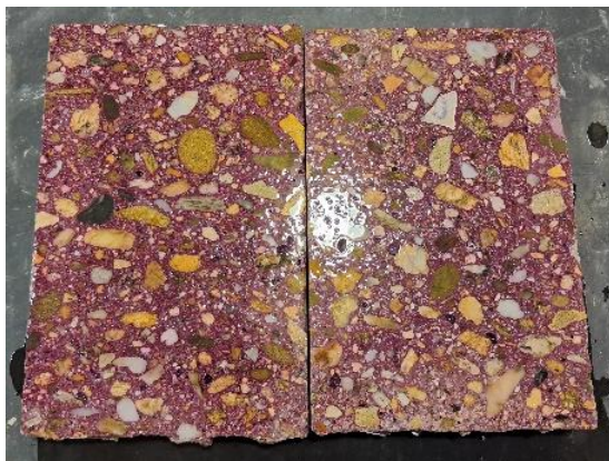
Obr. 21 - Vzorky připravené na mikroskopickou analýzu obsahu kameniva v betonu
