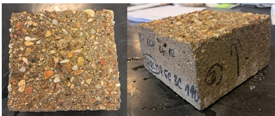
Obr. 37 – Vzorek po zkoušce CHRL – povrch vzniklý pomocí PTFE vložky bez nátěru hran – receptura 3C
