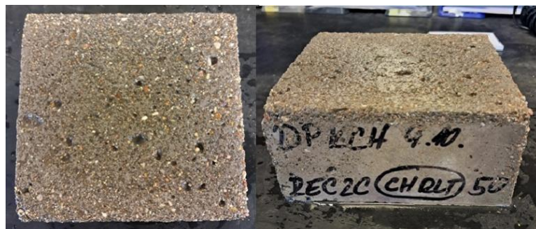
Obr. 62 – Vzorek po zkoušce CHRL – povrch vzniklý pomocí PTFE vložky bez nátěru hran – receptura 2C
