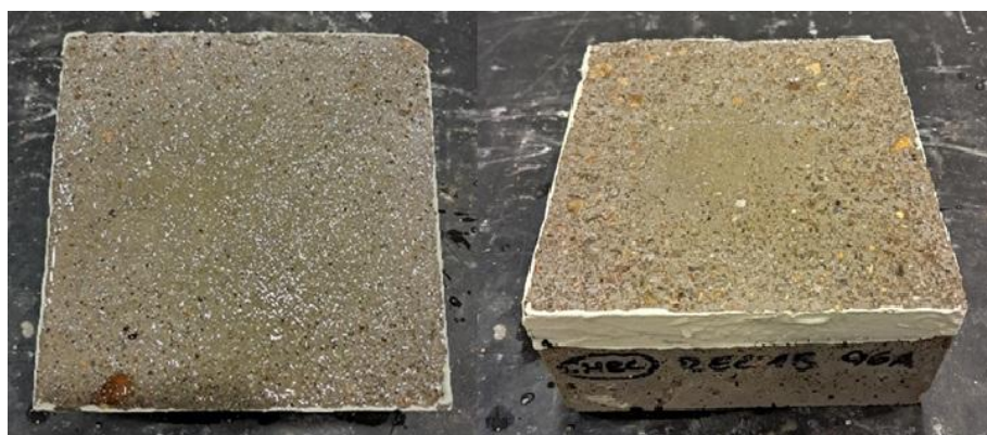
Obr. 38 – Vzorek po zkoušce CHRL – původní povrch s nátěrem hran – receptura 1B
