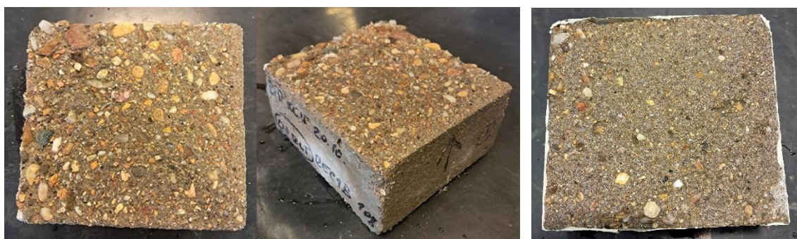
Obr. 40 – Vzorek po zkoušce CHRL – povrch vzniklý pomocí PTFE vložky s nátěrem hran – receptura 1B
