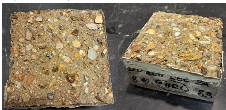
Obr. 48 – Vzorek po zkoušce CHRL – povrch vzniklý řezem s nátěrem hran – receptura 2A
