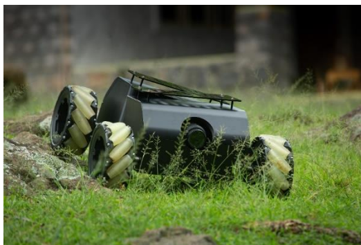
Obrázek 2.2: Příklad Konfigurace Omnidirectional Wheels[6]
