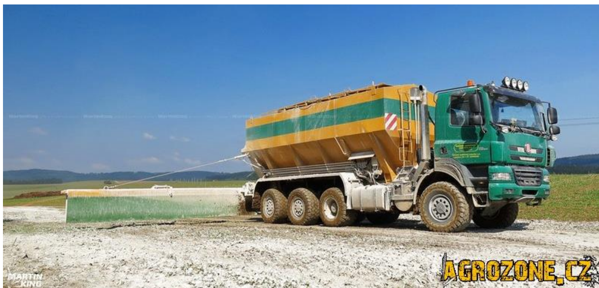
Obr. 1.2 Tatra Phoenix T158 v konfiguraci náprav 1+3 při aplikaci mletého vápence [10]
