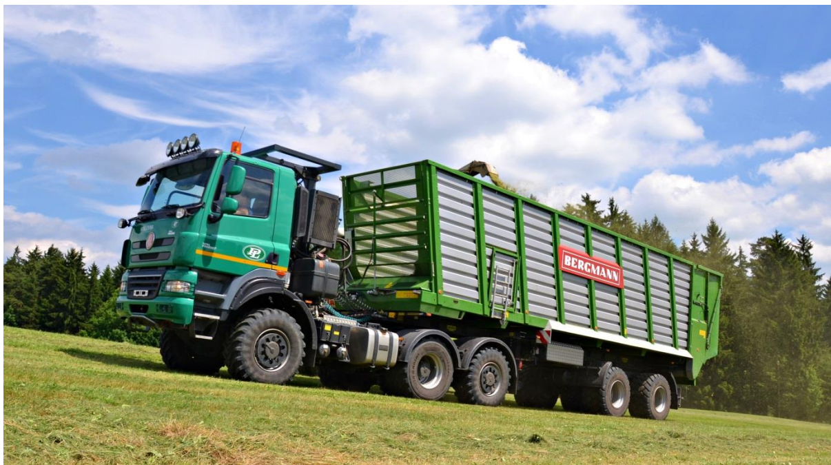
Obr. 1.3 Agrotahač Tatra Phoenix T158 6x6 + podvozek Umikov NP2 s nástavbou Bergmann HTW 65 při sklizni travní senáže
