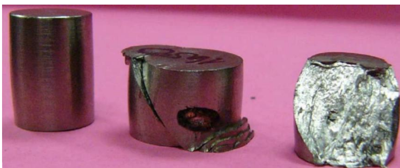
obr. 10 Lom vzniklý při pěchování tělesa [1]
