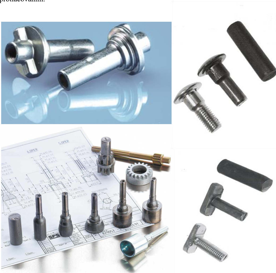
Obr. 1 Příklady součástí vyráběných protlačováním [9], [20], [32],
