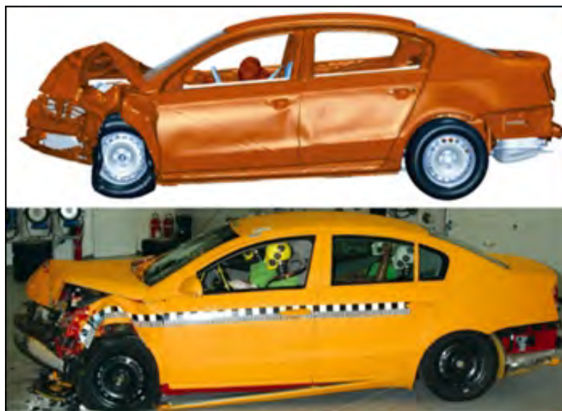
Obr. 12. Výsledek simulované a skutečné bariérové zkoušky..
