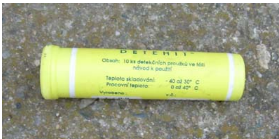
Obrázek 17 - Detektor nervově-paralytických látek DETEHIT
