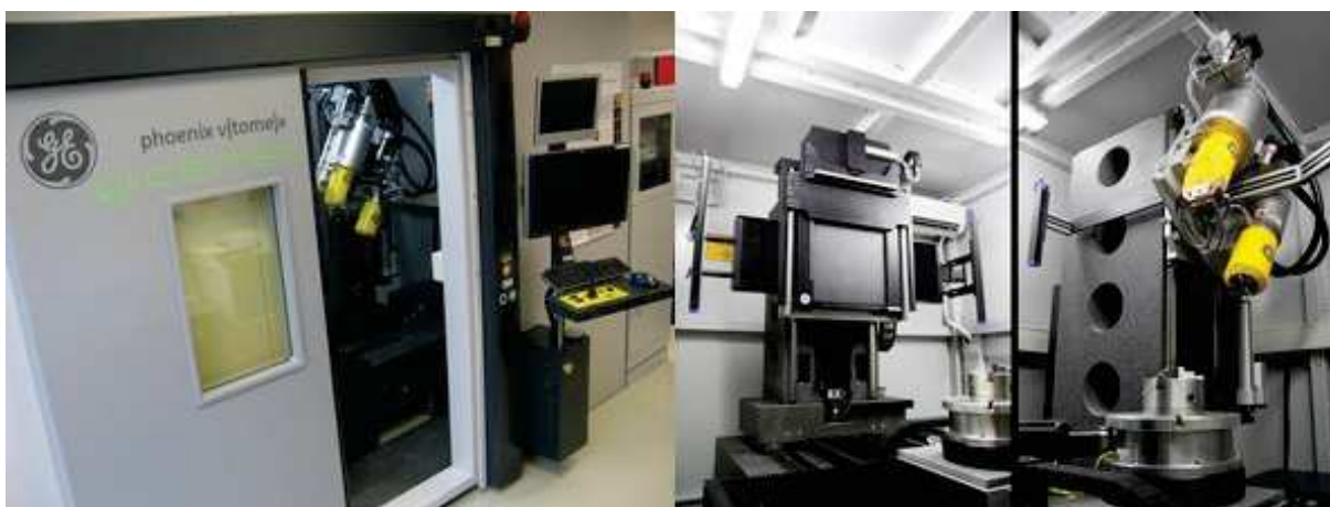
Obrázek 13: Zařízení GE phoenix v|tome|x L240 [34]
