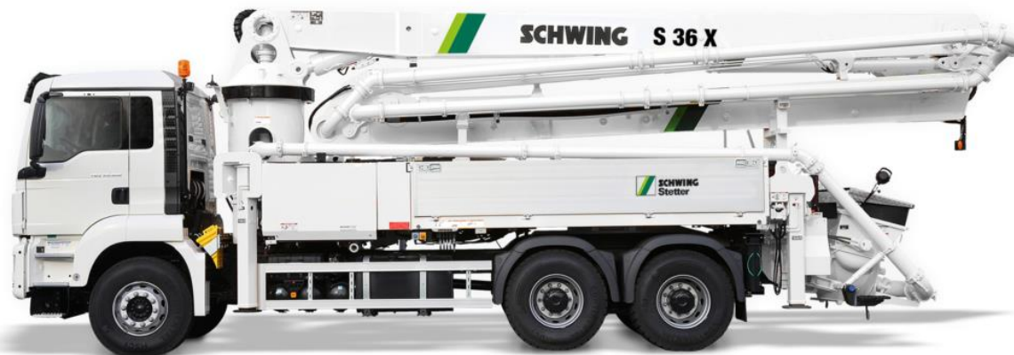
Obr. 6.19 Čerpadlo na beton Schwing S36X [33]
