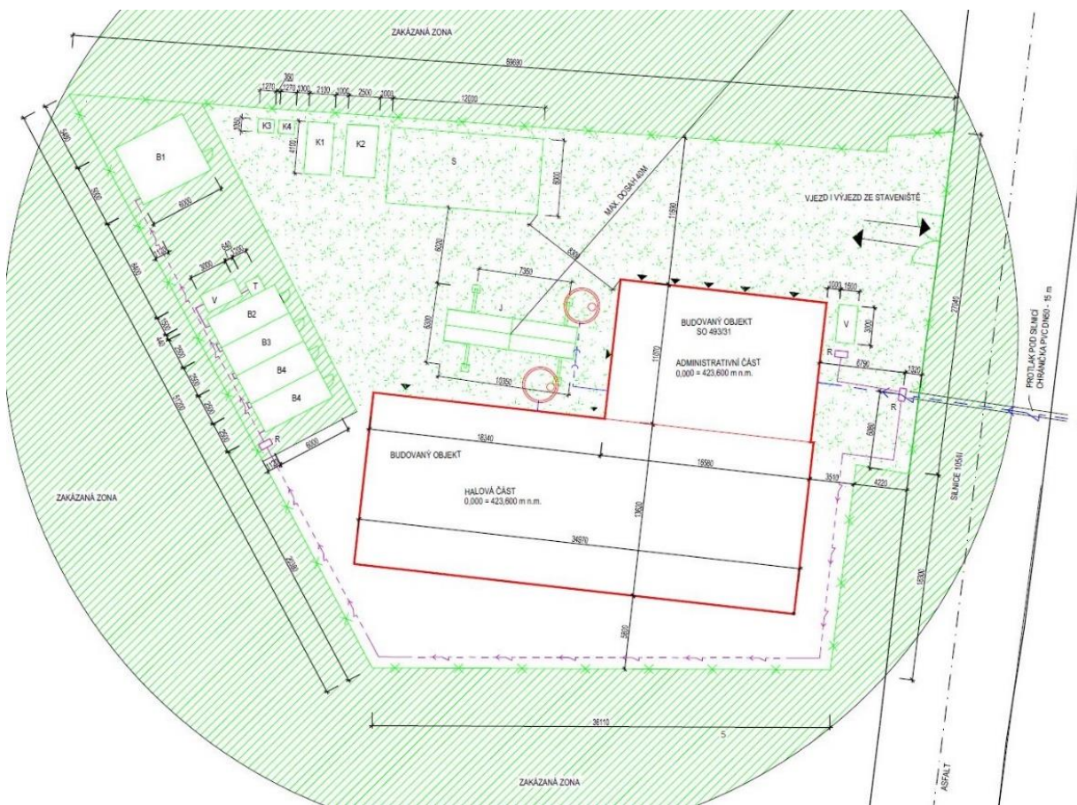
Obr. 4.1 Výkres zařízení staveniště [obrázek autora]
