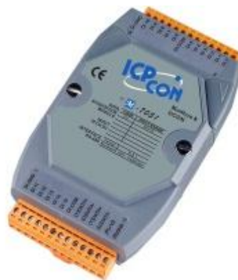
Obr. 3.1 Modul digitálních vstupů M-7051-G [2]
