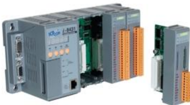
Obr. 3.3 Modulární jednotka I-8431-MTCP s rozšiřující kartou [3]
