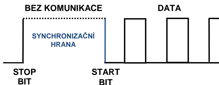
Obr. 4.5 Synchronizace dat na RS-232
